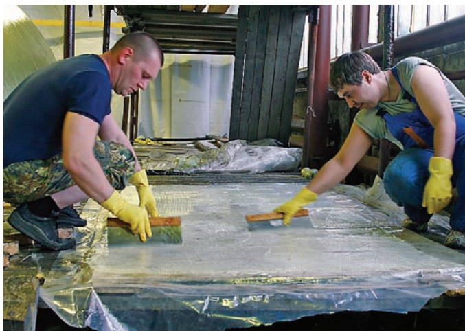
Разложена стеклоткань, отмеренное количество смолы распределяется шпателями
