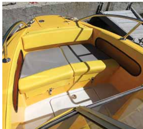
Под посадку водителя подстраиваются и кресло, и штурвал. В палубе кокпита – крышки просторных трюмных отсеков
