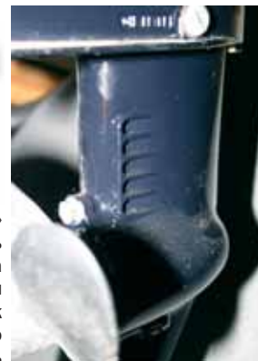
Рис. 6. Хотя на 2.5-сильный «Tohatsu» теоретически возможно установить жестяные интерцепторы, давления на развиваемой с его помощью скорости все равно не хватит, да и водозаборник расположен так, что струю от гребного винта тоже не задействовать
