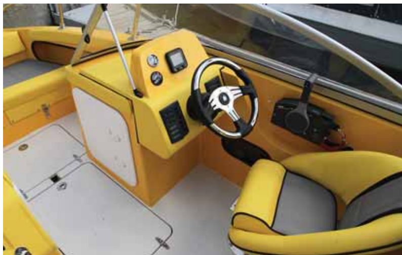
Под посадку водителя подстраиваются и кресло, и штурвал. В палубе кокпита – крышки просторных трюмных отсеков
