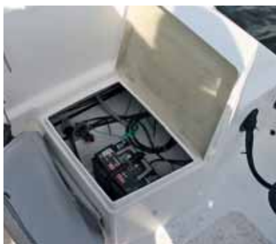
Оба кормовых рундука — «служебные». В одном установлен аккумулятор, в другом — 75-литровый бензобак
