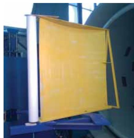
Рис. 7. Модель в аэродинамической трубе
