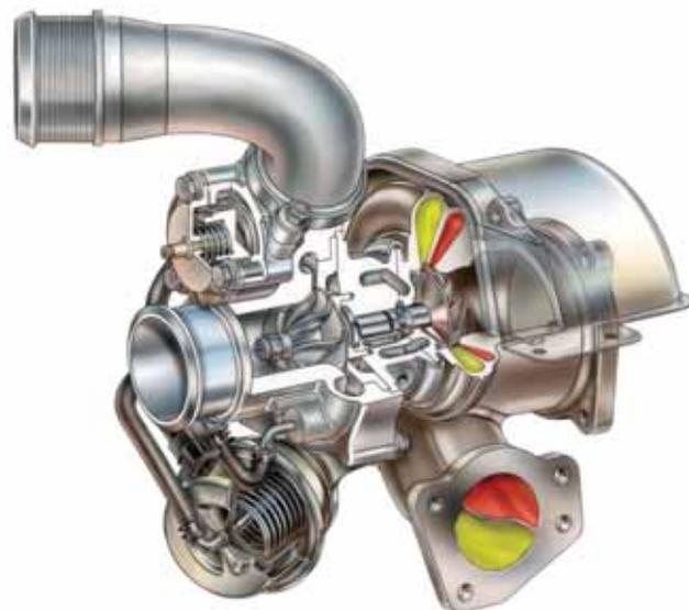
*Турбокомпрессоры с двухпоточной турбинной частью обладают более широким диапазоном эффективной работы по сравнению с однопоточными*
