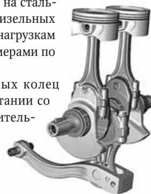
Система уменьшения вибраций рядного 2-цилиндрового 4-тактного двигателя с равномерным чередованием вспышек в цилиндрах, используется на мотоциклетном агрегате BMW F800. Системы такого типа могут использоваться на одно- и двухцилиндровых массовых ПЛМ, в данном случае полностью уравновешиваются силы инерции первого порядка, силы инерции второго порядка – свободны
