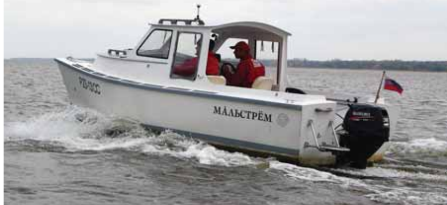
Рис. 5. Скоростной катамаран активно режет воду, но сидит глубоко – он не глиссирует
