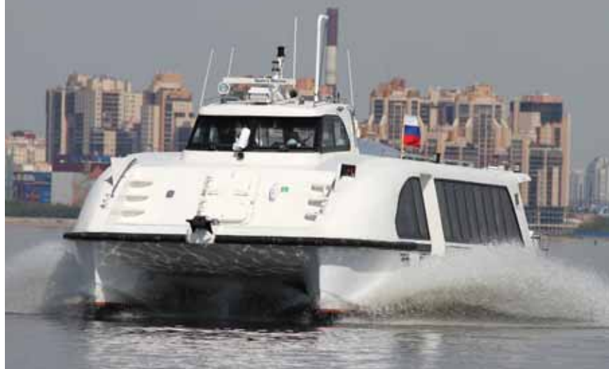
Рис. 5. Скоростной катамаран активно режет воду, но сидит глубоко – он не глиссирует
