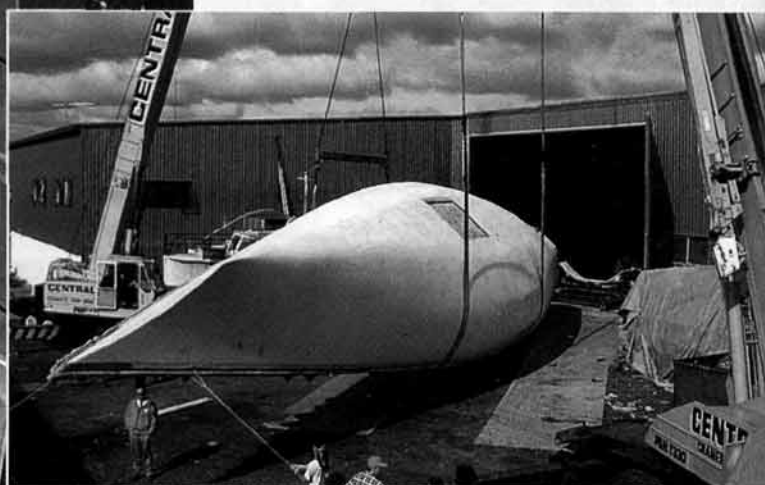
Готовый болван передается в цех для формования корпуса. В дальнейшем был оборудован как копия готовой яхты и демонстрировался в различных городах страны как своеобразный аттракцион во время "агитационной кампании".
