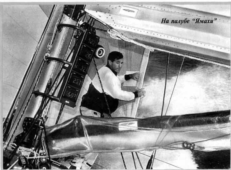
Рангоут из алюминиевого сплава; изготовлен, как и на "Эндевур", фирмой "Southern Spars" (Окленд)
