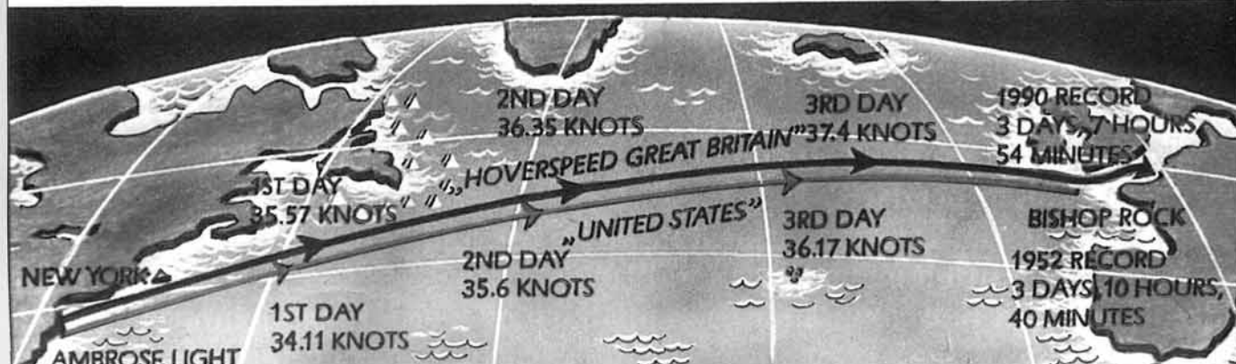
Сравнение среднесуточных скоростей двух рекордных переходов: лайнера "Юнайтед Стейтс" (верхний снимок) в 1952 г. и катамарана "Си Кэт" в 1990 г.
