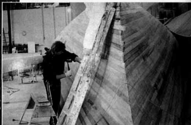
Изготовление деревянного болвана (пуансона) для формования корпуса
