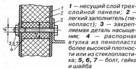
**Типовое крепление деталей насыщения небольшого веса к трехслойной панели**
