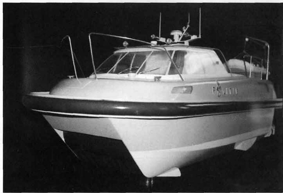
**Модель патрульного варианта водометного скегового СВП "Фливер-1200" (возможна модификация с приводами Арнесона)**
