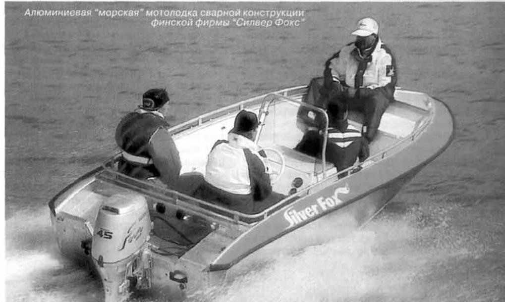
Алюминиевая "морская" мотолодка сварной конструкции финской фирмы "Сильвер Фокс"
