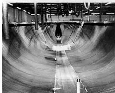
**Соединение двух секций корпуса, отформованного с применением армирующего материала из тварона, углеволокна и стеклотканей**
