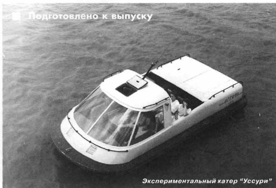
При мощности двигателя "УМЗ-412" 60 л. с. катер с угловой колонкой ПОК-60 развивал скорость на тихой воде — 47 км/ч, на волне высотой 0.4 м — 41 км/ч. Расход топлива на 100 км пути при скорости 42.7 км/ч составил 21.8 кг. Тогда же во Владивостоке, а затем в Хабаровске наш СВП успешно прошел всесторонние испытания.
