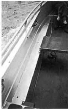
гурятником. Эта трубчатая конструкция очень удобна при переноске лодки, при подъеме пловцов из воды через транец (имеется также и откидной трапик), для работы по замене винта или шпонки при откинутом моторе. Такое решение было не только замечено, но и высоко оценено финскими судостроителями: крма "Мастера-500" получила титул "коры года..."
