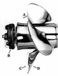
Винт с двухшаговым мультипитчем: А – автоматическое изменение шага на 152 мм; В – ручной регулятор установочного шага; С и Д – положения лопасти в позициях увеличенного шага и шага для движения малым ходом
