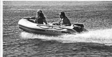
В конце 1996 г. к числу хорошо известных надувных лодок фирмы “Quicksilver”, выпускавших под фирменные моторы мощностью от 4 до 25 л.с., примкнула новинка “Rhino” – четырехместная, 3,05-метровая лодка под 15-сильный “Mercury”.
