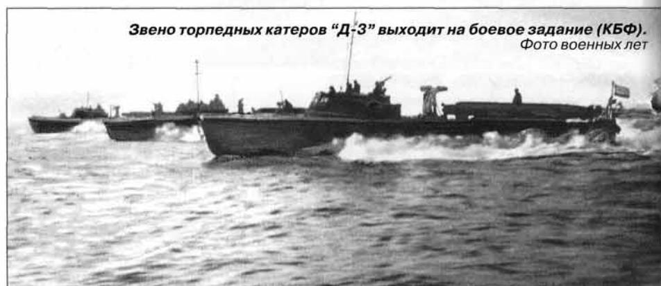
и продолжительную крейсерскую скорость 37 уз, при которой дальность плавания составляла 350 миль; при скорости 18—20 уз дальность плавания увеличивалась до 550 миль.
