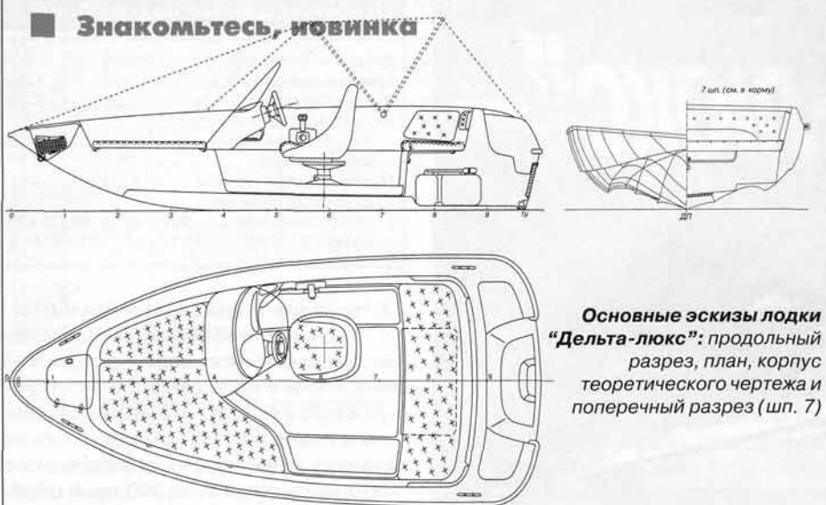
**Основные эскизы лодки "Дельта-люкс": продольный разрез, план, корпус теоретического чертежа и поперечный разрез (шл. 7)**
