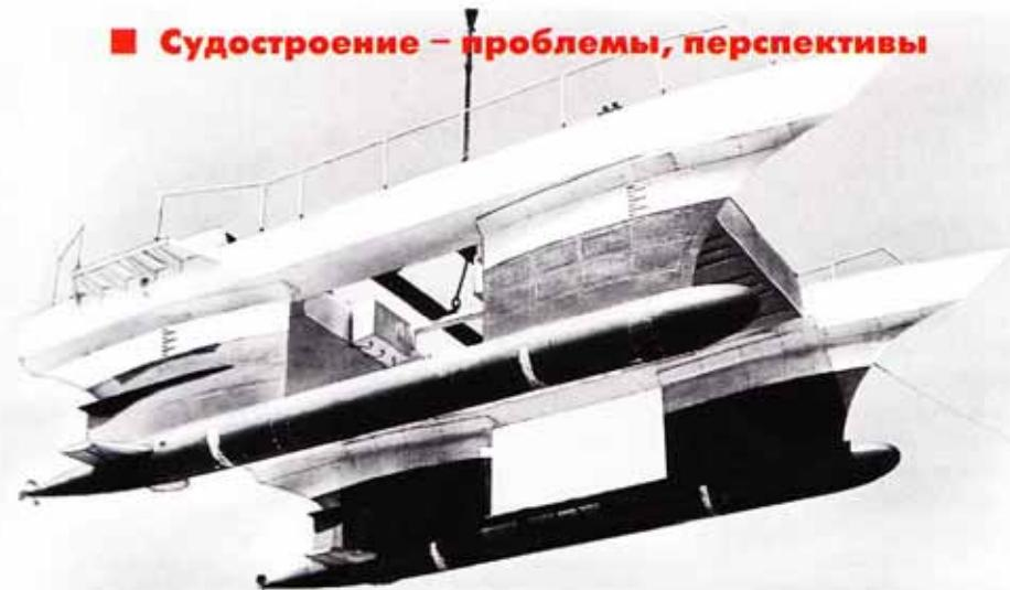
Полунатурный макет судна с малой площадью ватерлинии, испытанный ЦНИИ им. акад. Н. Крылова на открытой акватории
