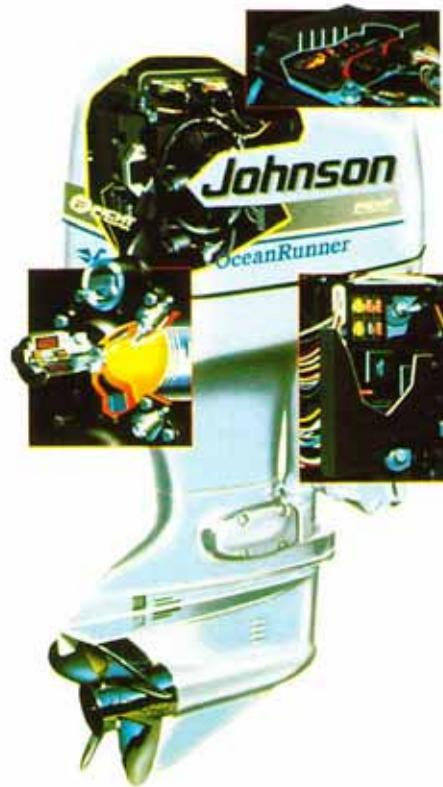
**Мотор нового поколения "Johnson 150 Ficht Fast Strike" с прямым впрыском топлива**
