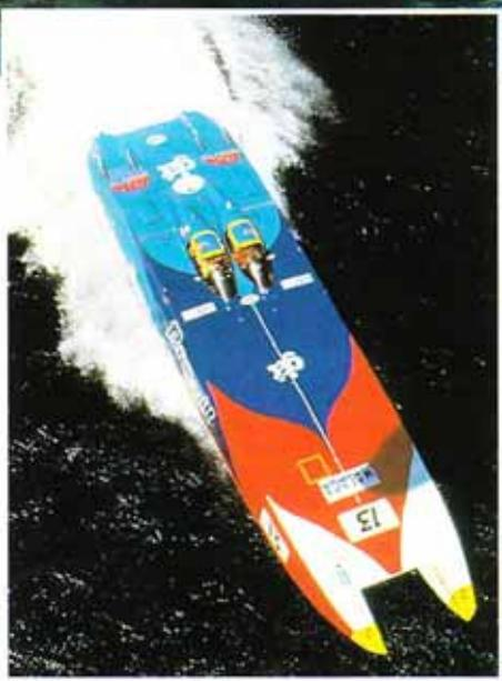
**Этот 13.98 метровый катер "Бразил", корпус которого изготовлен из легкого сплава. Вес — 4.5 т.**
