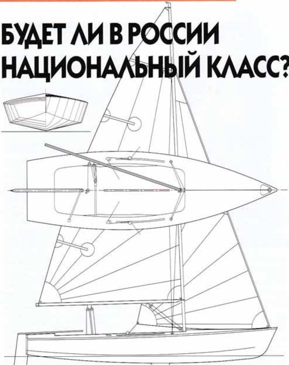
**Общий вид и эскиз теоретического чертежа ("корпус") швертбота-тройки "Sid 605" по проекту И. Сиденко.**
