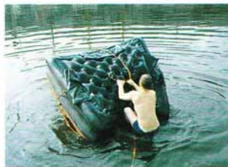
**Испытание плота на переворачивание**
