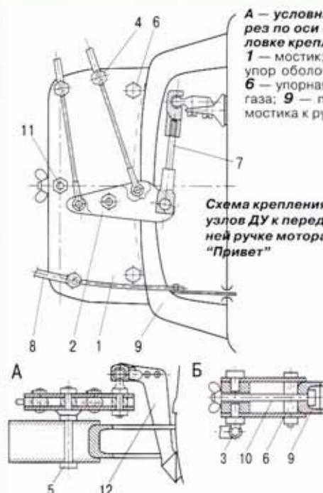
**A — условный разрез по вертикальной оси качалки; Б — разрез по оси крепления мостика к ручке ПМ и сферической головке крепления тяги штуртроса.**
