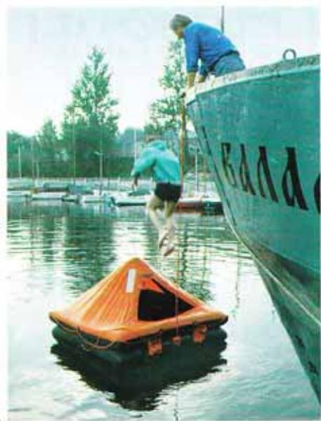
**Испытание плота прыжком при аварийной посадке**
