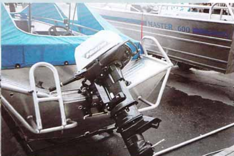
Наверху — результат совместной работы "адмиралтейцев" и изготовителей "Нептуна": лодка "Мастер-450" специально под мотор с удлиненным дейдвудом
