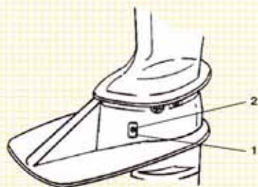
Рис. 2. Установка цинковых протекторов
