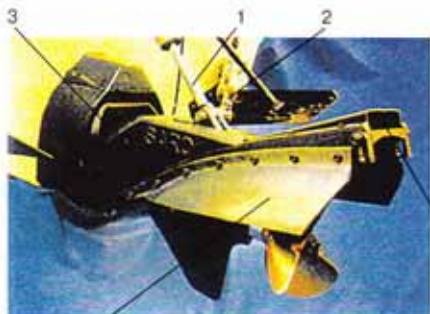
Схема расположения подводных крыльев (вогнуто-выпуклого симметричного профиля) на яхте "Macro Spaceshuttle"
