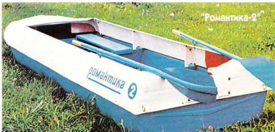
**Материал** безнаборного гофрированного корпуса — АМг. Изготовитель лодки — Тушинский машзавод. Основные минусы: Невысокие скоростные и мореходные качества (разрешено использование при высоте волны до 0,25 м), большое число секций.
