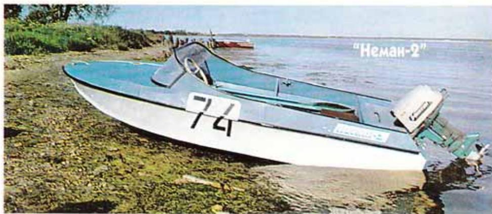
**Материал корпуса — АМг. Изготовитель — Калининградский завод "Янтарь". Основной минус: Сложности хранения и транспортировки, свойственные более крупным 4-5-метровым мотородамкам.**
