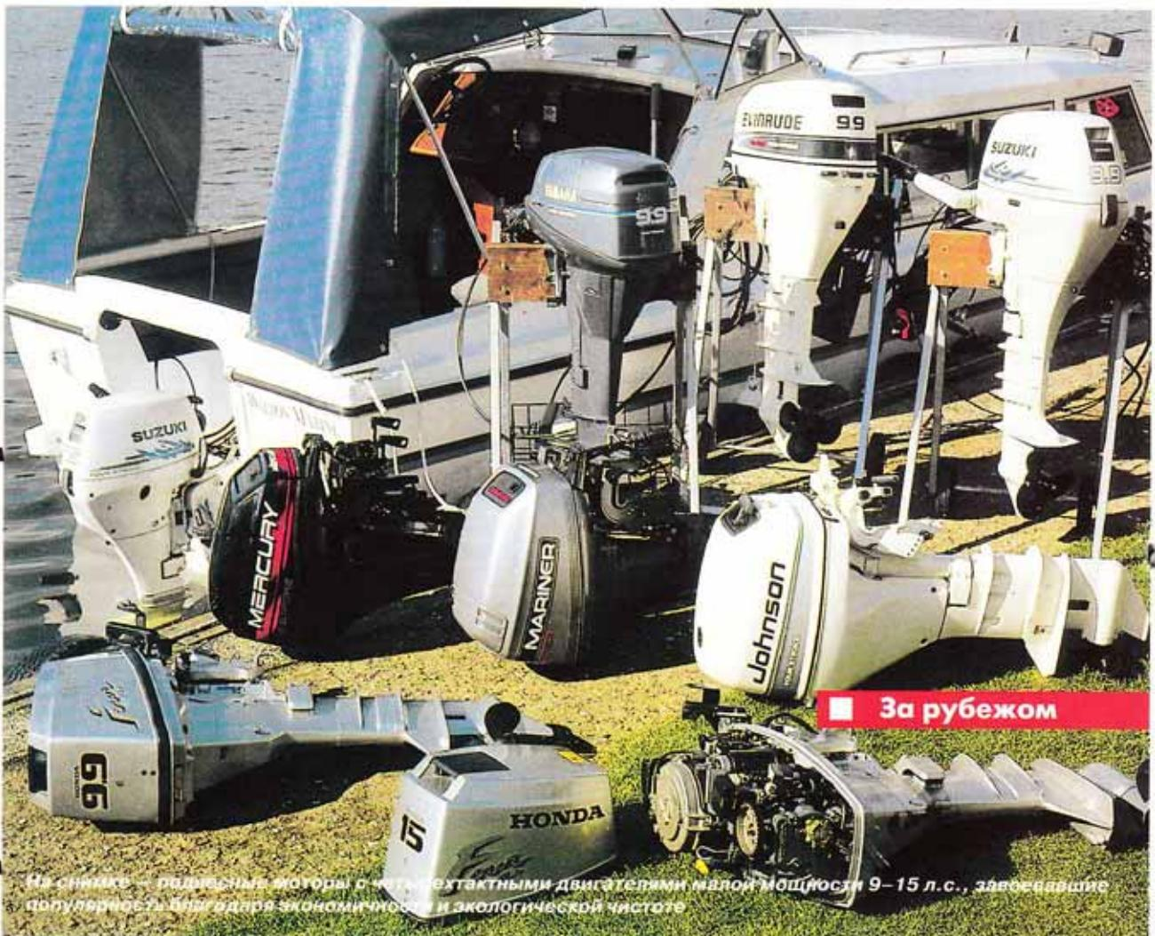
На снимке – различные моторы с четырехтактными двигателями малой мощности 9–15 л.с., завоевавшие популярность благодаря экономичности и экологической чистоте.
