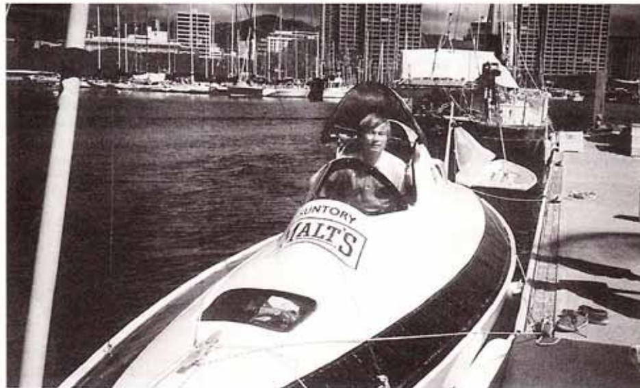
Эта 8-метровая пластиковая (сэндвич с легким наполнителем — пенопластом) педальная лодка с традиционным для яхт и лодок Кеничи Хори названием "Мермейд" ("Русалка") была специально спроектирована для состоявшегося в 1993 г. его очередного одиночного плавания через Тихий океан.
