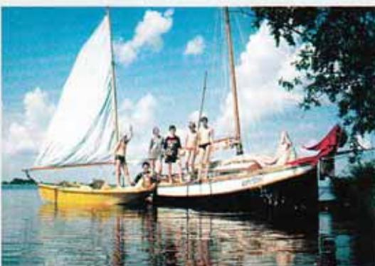
С первого взгляда, может быть, она и уступает "фирменным" картопам и швертботам из-за внешней простоты линий корпуса и плоского днища на миделе. Но такое мнение ошибочно! Она бегает просто изумительно, легко управляема, идет "на своей волне" — так удачно спроектированы ее обводы.
