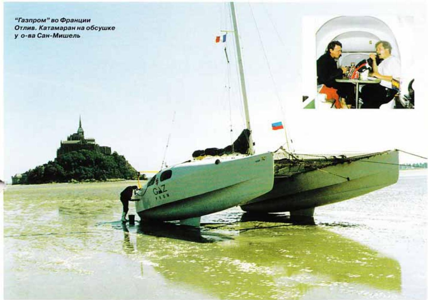
стал скромнее, а главное — был отформован "вхолодную". Но благодаря некоторым хитроумным наработкам "хотьковцев", общий вес пластиковых конструкций катамарана остался тем же — 1027 кг. Мачта "выросла" на метр и стала углепластиковой, основных парусов стало на 10 м<sup>2</sup> больше.
