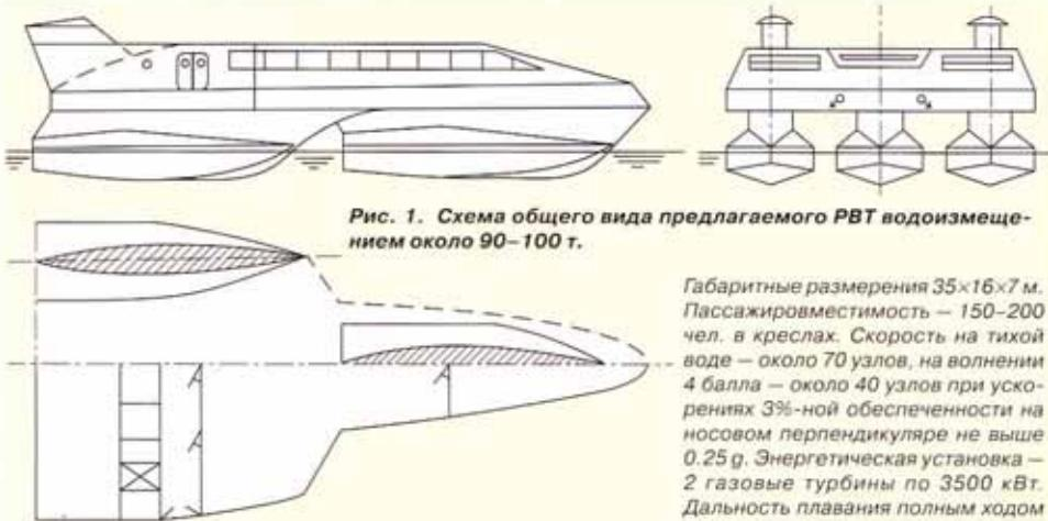
Рис. 1. Схема общего вида предлагаемого РВТ водоизмещением около 90–100 т.
