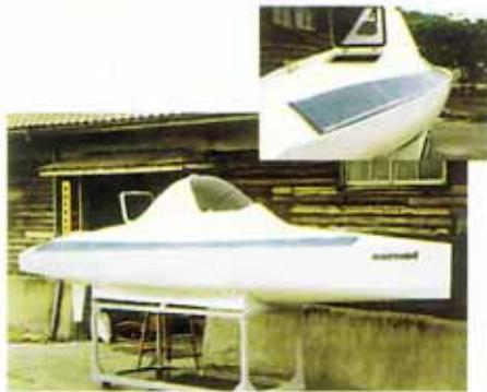
щикам на длинные дистанции. Работая педалями, Кеничи должен был иметь хороший обзор вперед через тонированное стекло рубки. На рукоятки руля велосипеда, соединенные штуртросной проводкой с баллером руля (мог быть включен и автопилот), следовало вывесить все необходимые выключатели, перед ним — разместить приборную доску.
