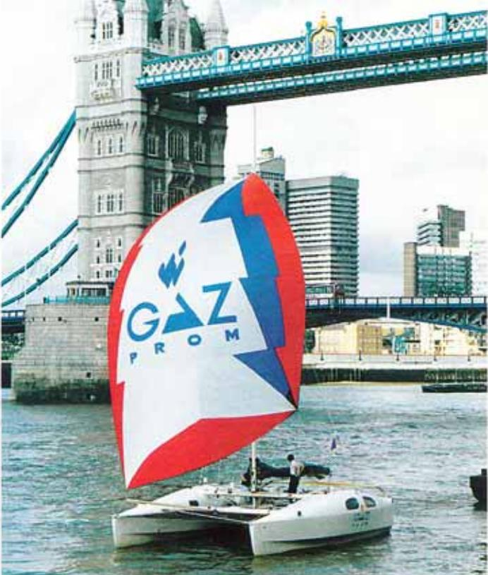
в нем экипажем и багажом "обмазан" пластиком и максимально разнесен по ширине на минимальном количестве балок-связей. (Ширина и вес — главные показатели, влияющие на скорость многокорпусника.)
