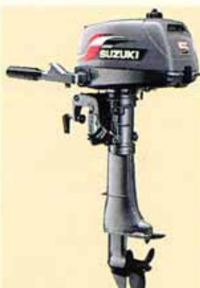
**Новый 5-сильный подвесной мотор "SUZUKI" с традиционным двухтактным двигателем**
