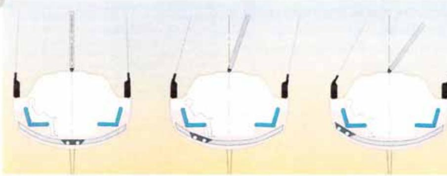
**Три положения мачты.** Слева — нагрузка на такелаж отсутствует, в центре — мачта с такелажем начинает наклоняться, в то время как балласт смещается к наветренному борту. Справа показан максимальный наклон мачты с такелажем, равный 35 градусам, и крайнее положение балласта.
