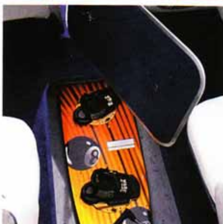
Люк в настиле — дне кокпита, открывающий доступ в нижний багажник для длинномерных предметов
