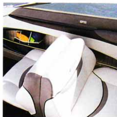
Сдвоенное раскладывающееся в диван пассажирское кресло нового типа
