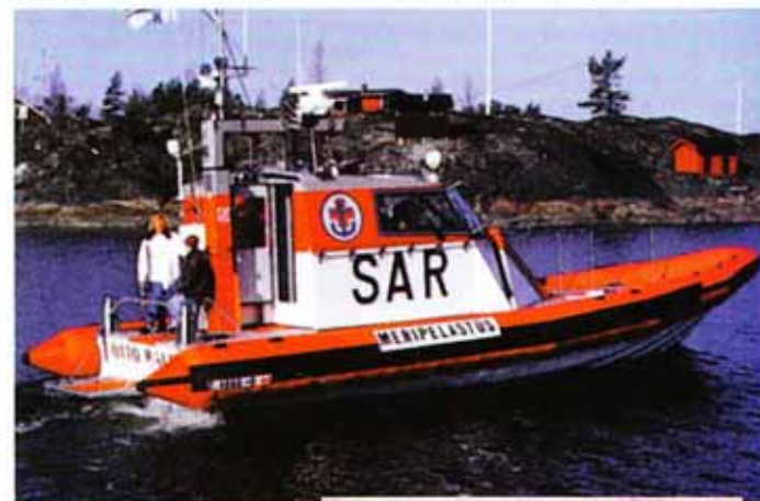
Всепогодный санитарный катер с надувными бортами фирмы Boomeranger. С двумя двигателями по 400 л.с. идет со скоростью 35 узлов
