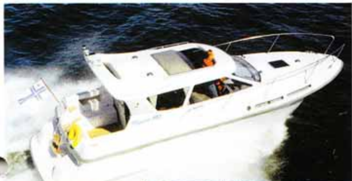
Два популярных стеклопластиковых каютных катера: "Flipper 999" (длина — 9.85 м; 10 чел.; дизель 230-400 л.с.) и "Bella 9000 Sunmar" (длина — 9.0 м; 10 чел.; дизель 200 л.с.) финской фирмы "Bella Boats"
