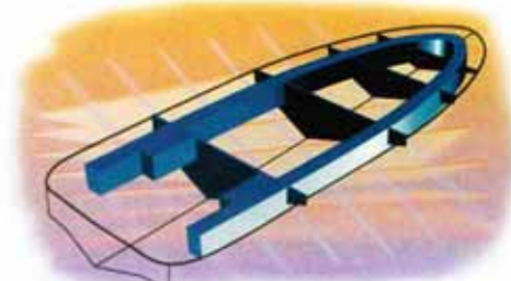
Типовая для большинства лодок секция днищевого набора, укладываемого на секцию обшивки
