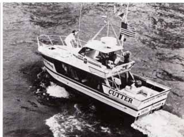
Первый катер с угловой колонкой, пересекший Атлантику. 45% его водоизмещения составлял запас дизельного топлива
