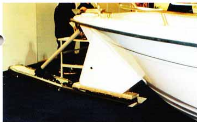
Отслеживающее волну носовое устройство для мореходных лодок
