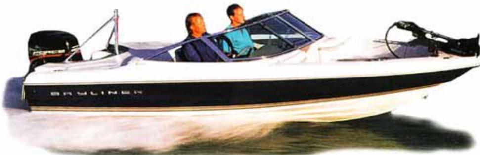
Рыболовная мотолодка типа "1904 Capri SF" с носовым кокпитом, уменьшенным основным кокпитом и поднятой кормовой "палубой". Поворотные кресла рыбака ставятся в гнезда, имеющиеся в носу и корме. Имеются садки для рыбы, ящички для наживки, крепления рыболовного подвесного электромотора. На фото показан поставленный в имеющееся гнездо пилон для воднолыжного фала.
