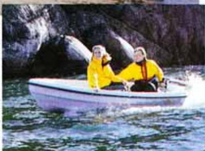
Привычный для северных вод закрытый вариант экономичного дизельного катера, неслучайно названного "Classic 707C". Длина — 7.0 м; ширина — 2.6 м; осадка — 0.65 м. Водоизмещение — 1.6 т. Двигатель 40-100 л.с. Выпускается фирмой "Sea-Star"
