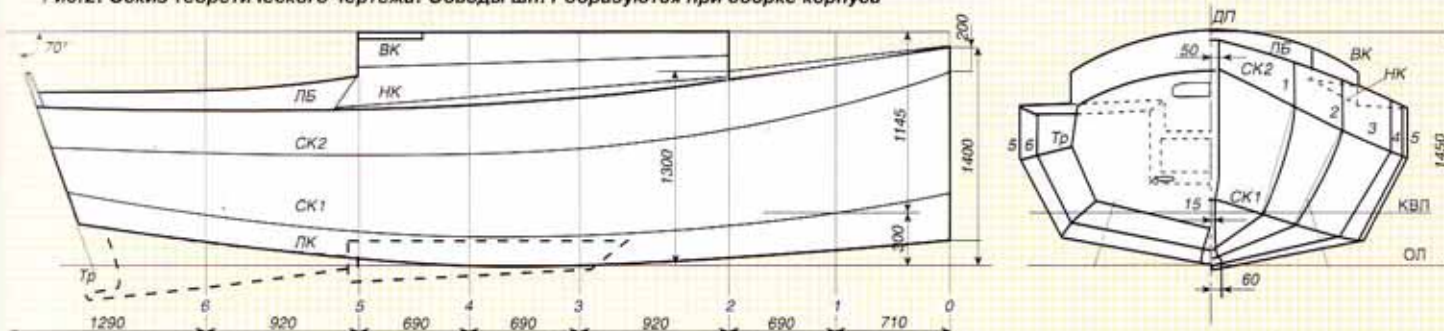
Рис. 2. Эскиз теоретического чертежа. Обводы шп. 1 образуются при сборке корпуса
