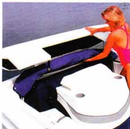
Звукоизолирующий капот двигателя в виде мягкого стола (с гнездами для стаканов) или сиденья
