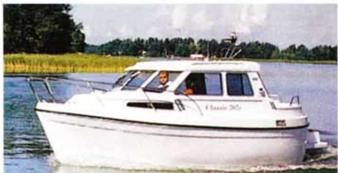
Привычный для северных вод закрытый вариант экономичного дизельного катера, неслучайно названного "Classic 707C". Длина — 7.0 м; ширина — 2.6 м; осадка — 0.65 м. Водоизмещение — 1.6 т. Двигатель 40-100 л.с. Выпускается фирмой "Sea-Star"
