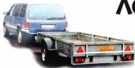
Прицеп МЗСА-81177-08 для перевозки одного гидроцикла. Грузоподъемность — 400 кг. Погрузочная высота — 334 мм, колея — 1335 мм. Шины — 165/80R13. Цена — 4,5 тыс. руб.
