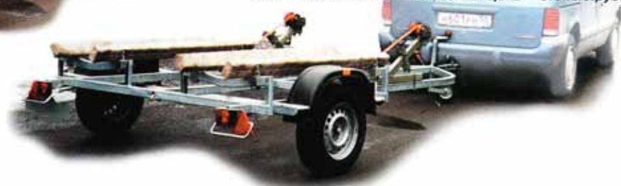
Прицеп МЗСА-81177-18 для перевозки двух гидроциклов. Грузоподъемность — 600 кг. Погрузочная высота — 540 мм, колея — 1995 мм. Шины — 165/80R13. Цена — 6,6 тыс. руб.
