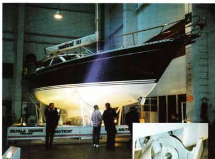
Самый крупный экспонат выставки — стеклопластиковая океанская яхта "Nauticat-515". Обращает внимание смонтированное на форштевне выдвижное подруливающее устройство "Retract"
