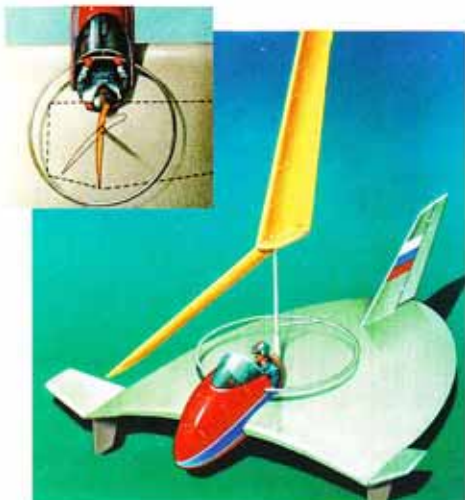
Одноместный экраноплан с V-образным "качающимся" жестким крылом
