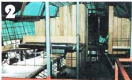
2 Затем внутри корпуса устанавливаются основные узлы интерьера и обстройки, включая путенс-планки, степс мачты, переборки, пиллерсы и т.п.
