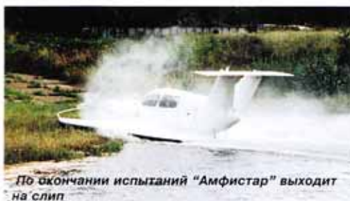
Мощные струи воздуха от соответственно развернутых винтов приподнимают судно, и оно начинает скользить по слипу к воде
