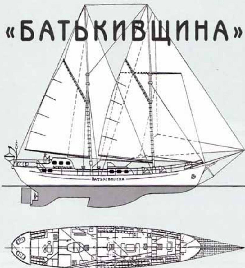
Киевский крейсерский яхт-клуб по праву считается основоположником применения армоцемента в яхтостроении. Последняя киевская новинка — разработка технологии наружного покрытия армоцементом старых стальных корпусов. Таким образом на базе серийных моторных судов, построенных сорок лет назад, созданы два крупных экспедиционных парусника. На схеме и фото — армоцементная шхуна «Батькивщина». Площадь парусности — 250 м 2 . Под 120-сильным двигателем судно развивает скорость 8 узлов.
