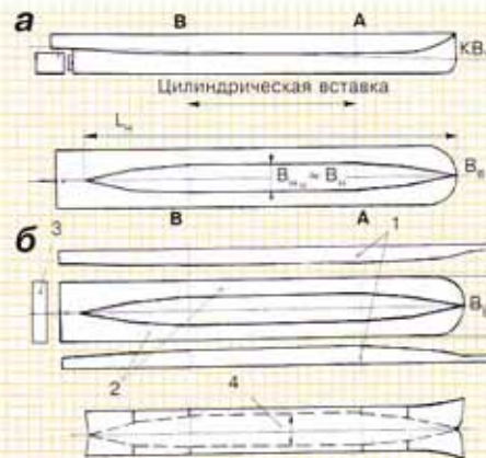
Рис. 2. Корпус (в плане) водоизмещающе-гליссирующего судна: а — с цилиндрической вставкой почти по всей длине и б — с ромбовидной водоизмещающей частью
