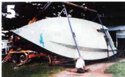
5 После того, как готова палуба (нанесены слой пенополиуретана, а затем стеклопластик), яхта переворачивается вверх килем
