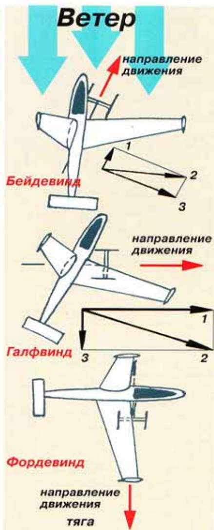
1- сила тяги, 2- полная аэродинамическая сила, 3- сила дрейфа
