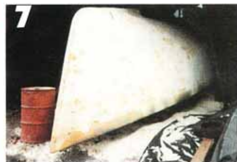
7 Излишки полиуретана счищаются до уровня сетки. После этого корпус покрывается слоем стеклопластика
