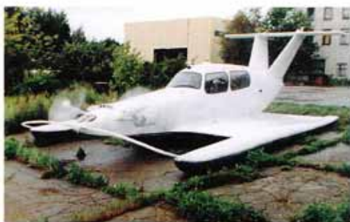
Мощные струи воздуха от соответственно развернутых винтов приподнимают судно, и оно начинает скользить по слипу к воде
