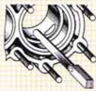
Определение износа цилиндра и зазора в замке поршневого кольца "Ветерка-8"
