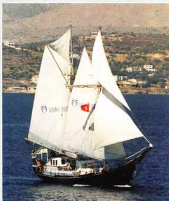
Киевский крейсерский яхт-клуб по праву считается основоположником применения армоцемента в яхтостроении. Последняя киевская новинка — разработка технологии наружного покрытия армоцементом старых стальных корпусов. Таким образом на базе серийных моторных судов, построенных сорок лет назад, созданы два крупных экспедиционных парусника. На схеме и фото — армоцементная шхуна «Батькивщина». Площадь парусности — 250 м 2 . Под 120-сильным двигателем судно развивает скорость 8 узлов.
