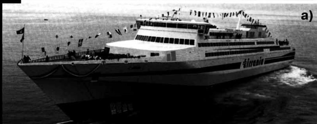
Крупнейшее однокорпусное скоростное водометное судно-паром типа "MDV 3000 Yupiter": а — в момент спуска на воду на верфи "Финкантиери" 10 января 1998 г.; б — на ходовых испытаниях (скорость при дедейте 800 т — 44 узла); в — схема общего вида; г — схема компоновки двигательно-двигательного комплекса: 1 — ВД с приводом от дизеля; 2 — ВД с приводом от ГТД; 3 — дизель; 4 — газотурбинный двигатель (ГТД); 5 — вспомогательный дизель-генератор
