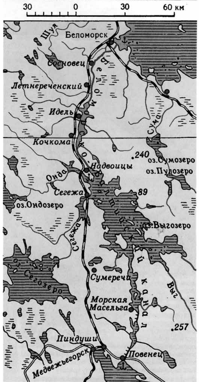
БЕЛОМОРСКО-БАЛТИЙСКИЙ КАНАЛ , соединяет Белое море (у г. Беломорск) с Онежским озером (у г. Повенец) и через Волго-Балтийский водный путь — с Балтийским морем и бассейном реки Волги. Построен в 1933 г. Общая длина 227 км; 19 шлюзов, 15 плотин, 49 дамб, 12 водоспусков. Кроме искусственного пути (37 км) Беломорско-Балтийский канал включает реки Выг и Повенчанка, а также Выгозеро, Водлозеро, озера Узкое, Маткозеро. Средняя глубина 5 м. Допускается проход кораблей и судов смешанного (речного и морского) плавания.
