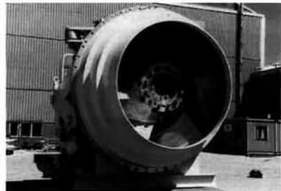
Самый мощный в мире водомет "KaMeWa" типа 180 SII для паромов "MDV 3000"
