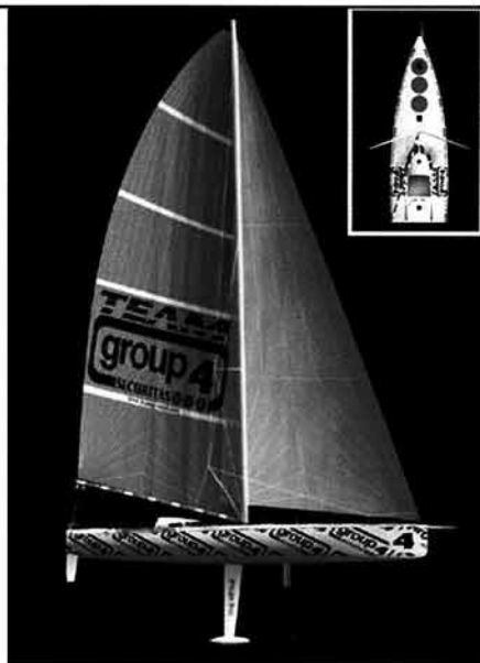
“Team Group 4”. Конструктор — Фино/Конк. Год постройки — 1998. Основные данные: Длина наиб. — 18.2 м; длина по ВЛ — 18.2 м; ширина — 5.75 м; ширина с учетом размаха красниц — 11 м; осадка — 4.5 м; водоизмещение — 8 т; парусность: на острые курсы — 280 м 2 , на полные курсы — 500 м 2 . Материал корпуса — углепластик.
