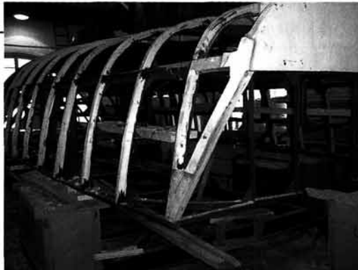
Подготовка шпангоутов к укладке реек обшивки
