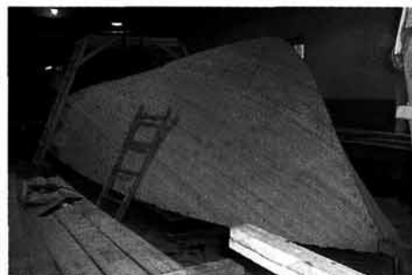
Корпус готов к обработке перед покрытием смолой
