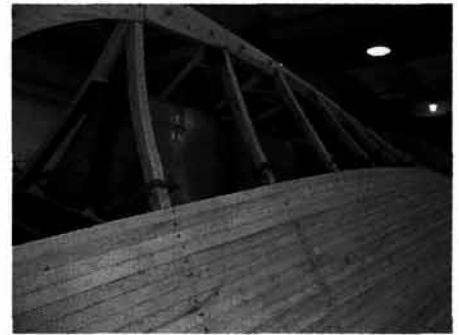
Укладка реек обшивки в носовой части корпуса
