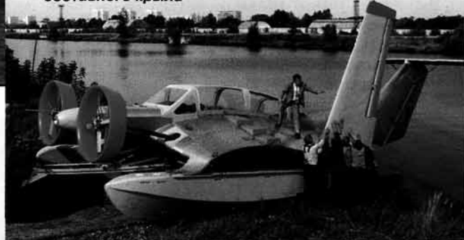
“Иволга” у причала: просматривается весь контур составного крыла
