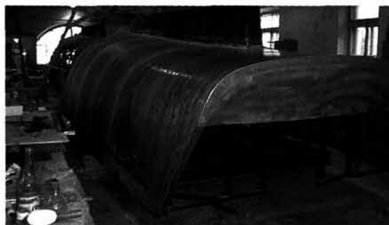
Пропитка смолой и укладка стеклоткани в кормовой части
