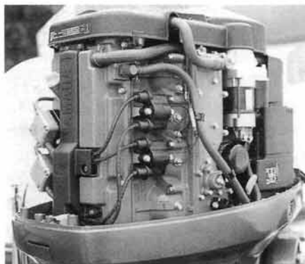
Работой 16-клапанного (DOHC) механизма газораспределения (верхний снимок) и системы зажигания управляет микропроцессор (блок с правой стороны двигателя на нижнем снимке)
