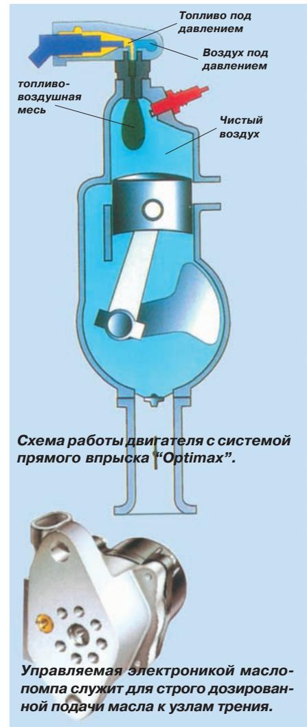
Схема работы двигателя с системой прямого впрыска "Optimax".
