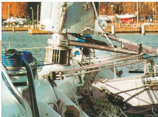
Нижняя часть мачты-крыла с румпелем и таями для ее поворота. Внизу виден скошенный конец (пятка) гика, упертый в балку.
