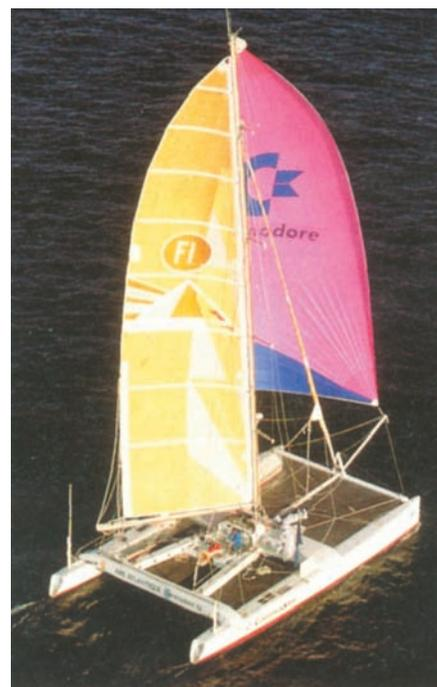
*Знаменитый катамаран в бытность свою "Коммодором Эксплорер". Хорошо видно, что он ставил рекорды, имея обычную "цилиндрическую" мачту, а не поворотное крыло, и классическую схему с вертлюгом гика на мачте.*
