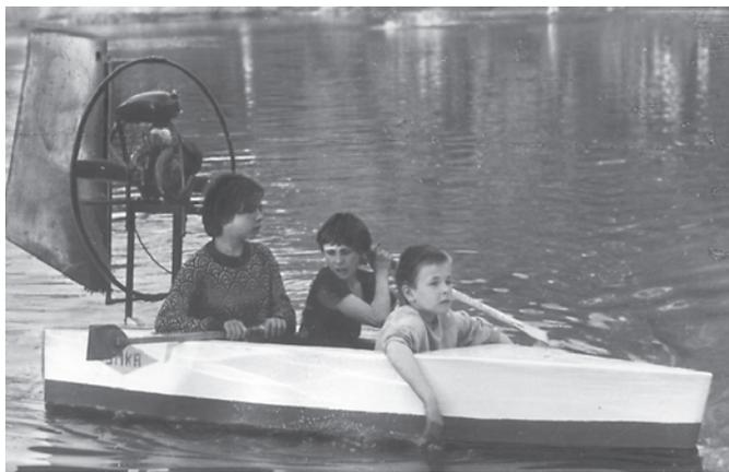
**"Умка" — лодка с воздушным винтом (двигатель от бензопилы). Это первая удачная конструкция, сделанная ребятами центра технического творчества.**
