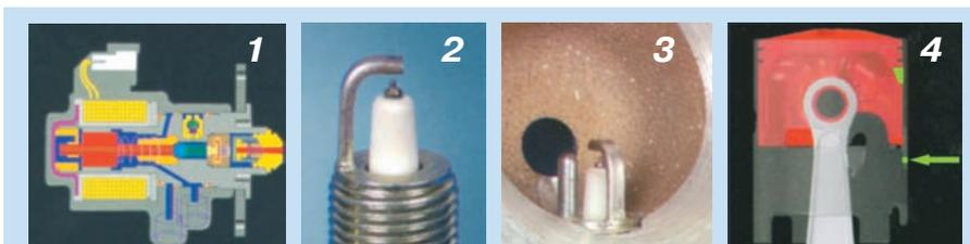
1. Электромагнитный клапан-отсекатель форсунки совершает до 100 циклов в секунду.
