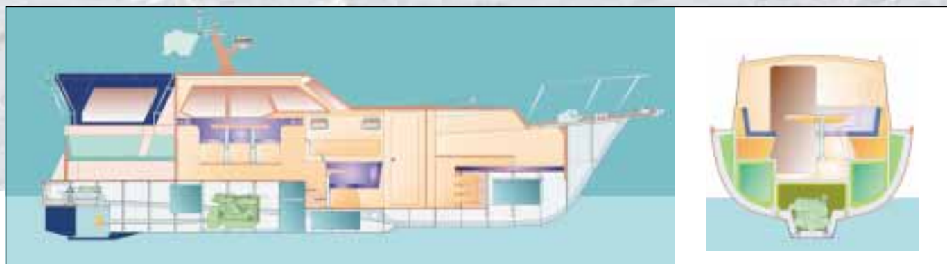
Общее расположение и основные характеристики моторной яхты "Навигатор 111": Длина наибольшая — 11,7 м, ширина — 3,3 м, осадка — 0,8 м. Водоизмещение — 4,5 т. Макс. скорость — 15 узлов при мощности 140 л.с. и 17 узлов при мощности 170 л.с. Крейсерская скорость — 12 и 15 узлов соответственно. Запас топлива (стандарт) — 620 л, воды — 270 л.
