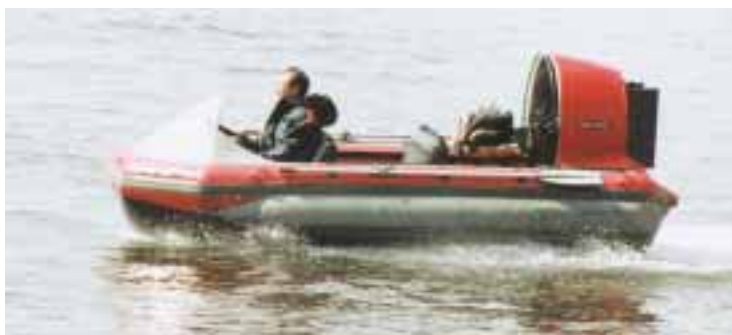
Малое СВН полностью надувной конструкции.
