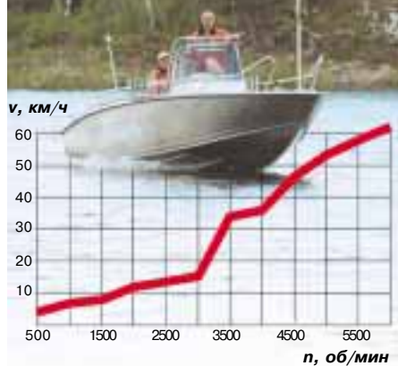
Результаты испытаний — график зависимости максимальной скорости хода от числа оборотов двигателя. На ПМ стоит оптимальный гребной винт — алюминиевый с шагом 19 дюймов.
