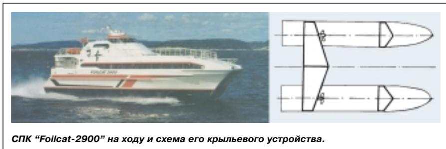
**СПК “Foilcat-2900” на ходу и схема его крыльцового устройства.**
