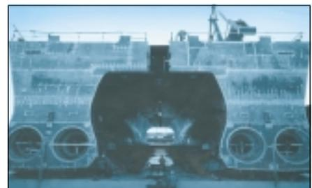
Вид на корму строящегося катамарана с уменьшением ширины корпусов в районе эксплуатационной ватерлинии.
