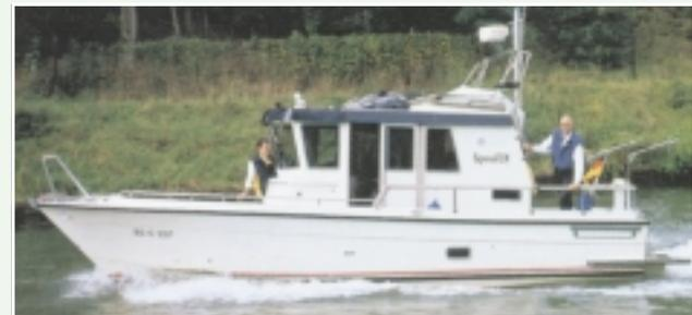
**Финский катер типа "Targa 30". Размерения: 9.05 x 3.15. Вес — 4500 кг. При установке двух 150-сильных дизелей TDI 150-5 катер развивает скорость 30.5 уз при 4000 об/мин, шумность — 79 дБ(А); при 3500 — 24.7 уз (77 дБ); при 3000 — 18.5 уз (73 дБ); при 2500 — 13.3 уз (70 дБ); при 2000 — 8.3 уз (69 дБ); при 1500 — 6.7 уз (65 дБ); при 1000 — 4.5 уз. Расход топлива на одну машину 12 — 15 л/ч на высоких скоростях.**
