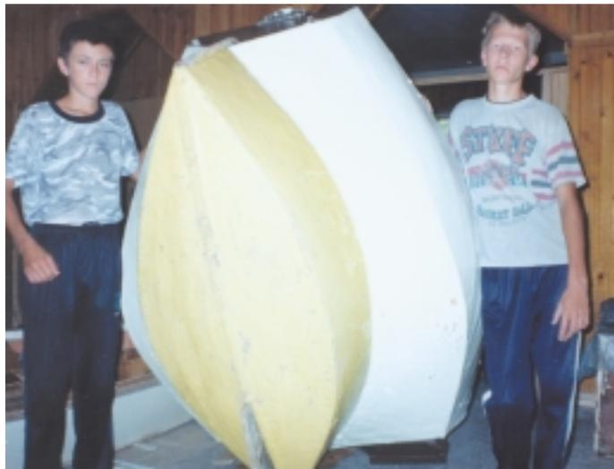
На низ килевой секции мы берем от 70 до 140 кг балласта; в принципе, вместо него для преодоления сильного течения можно было бы и установить малогабаритный стационарный двигатель мощностью около 6 л.с. Но это уже дело будущего.
