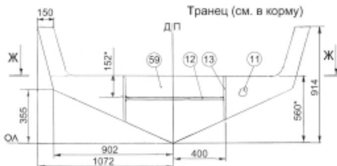
Поперечные сечения корпуса и конструкция транца.
