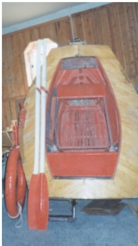
Фото этого самодельного плоскодонного джонбота редакция приводит главным образом для того, чтобы привлечь внимание к простейшему варианту удобной для рыбалки моторки под "Ветерок". Разумеется, речь идет о лодке для защищенных от волны внутренних водоемов, где ни плоское дно, ни малая высота борта не будут опасными.
