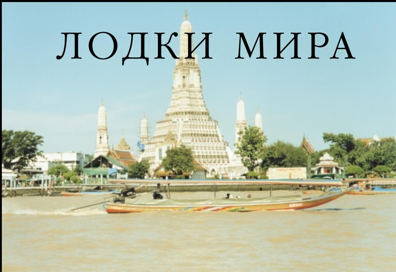
На этих снимках, сделанных в экзотическом Таиланде известным путешественником и фотографом — В.Снатенковым, изображены местные водоизмещающие лодки с самым распространенным в Юго-Восточной Азии видом движителя – мотор-веслом (или руль-мотором). Двигатель с воздушным охлаждением всегда на виду; погружение гребного винта позволяет регулировать скорость; гребной винт работает как высокоэффективный руль, что особенно важно при интенсивном движении на узких городских протоках.
