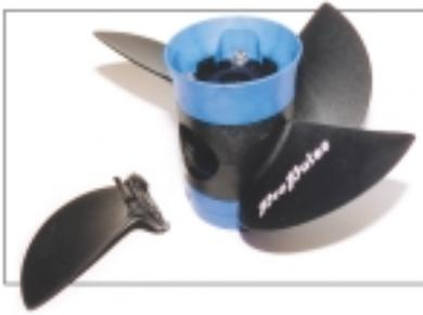
Швеция вновь доказала свое лидерство в части создания совершенных гребных винтов. Весной 1999-го года лодочный мир обошло известие о появлении композитного винта с четырьмя съемными лопастями, которые могут быть установлены на одну и ту же ступицу под пятью различными углами атаки (шаг винта соответственно: 12, 14, 16, 18 и 20 дюймов).
