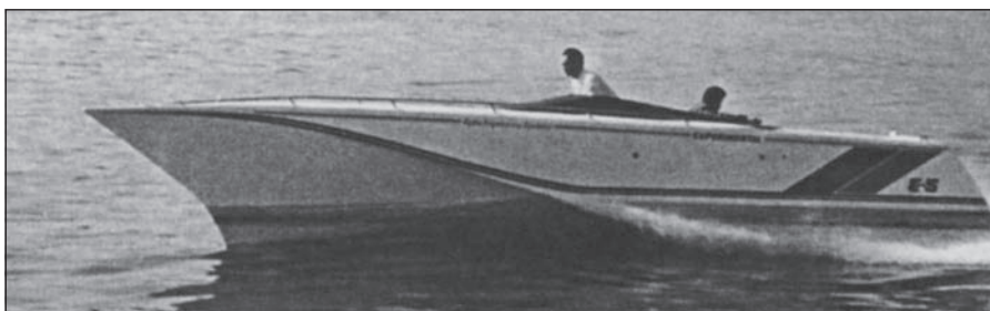
Одна из самоходных моделей Э.Х. Сертера "Е8" на испытаниях. Принцип построения обводов близок к моделям серии 7Х. Исследователь утверждает, что для катера с подобными обводами нет проблем преодоления "горба" сопротивления, нет носовой волны и брызг, отсутствует слемминг на ходу против встречной волны).
