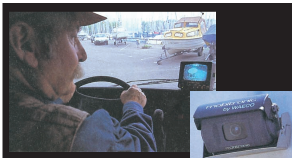
Как вы думаете, что это такое? Всего-навсего видеокamera, установленная на “хвосте” прицепа, и монитор в салоне машины. Выглядит круто, но при маневрировании задним ходом наверняка потребуются определенные навыки — поди сразу разбери, куда крутить руль, тем более что изображение на экране “прямое”, а не зеркальное. Думается, что без привычных зеркал даже при наличии такого “местного телевидения” все равно не обойтись. Подобные “бытовые” системы выпускаются за рубежом уже достаточно давно. Находятся и покупатели.
