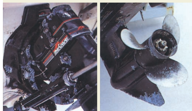
Рис. 3. Коррозия алюминиевой подводной части и гребного винта.
