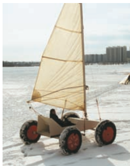
Снегокат нашей конструкции, упомянутый в 172 номере “Кия”. В кокпите — автор с масштабной моделью, на которой проверялась центровка.
