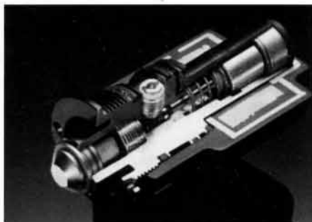
Рис. 2. Устройство инжектора "FICHT". Инжектор впрыскивает топливо под давлением в камеру сгорания с частотой 100 раз в секунду для более быстрого и полного сгорания.
