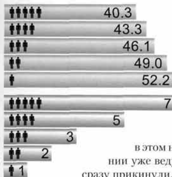
Максимальная скорость, км/ч (верхняя диаграмма) и время выхода на глиссирование, с (внизу) при нагрузке 1-5 чел.
