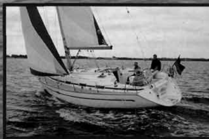
Парусная яхта BAVARIA-40 (Германия) полная длина 12,48м, длина корпуса 11,99м, длина по ватерлинии 11,15м, ширина на миделе 3,99м, осадка 1,85м (бульбашкиль..1,60м), высота мачты от уровня ватерлинии 17,05м, водоизмещение 7900кг, запас воды 300л, запас топлива 150л Цена от 100.495 евро
