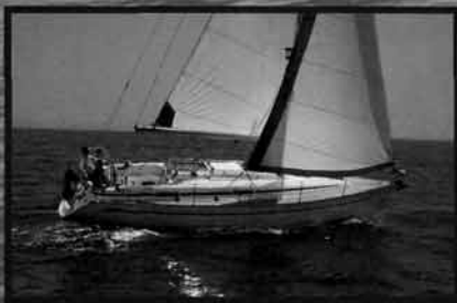
Парусная яхта BAVARIA-34 (Германия) полная длина 10,8м, длина корпуса 10,35м, длина по ватерлинии 8,45м, ширина на миделе 3,48м, осадка 1,85м (бульбашкиль..1,35м), высота мачты от уровня ватерлинии 14,54м, водоизмещение 4500кг, запас воды 150л, запас топлива 150л, двигатель 19 л.с. Цена от 67.835 евро
