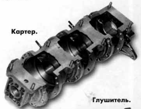
Основные детали 45-сильного двигателя на базе унифицированных узлов и деталей «Вихря-30».
