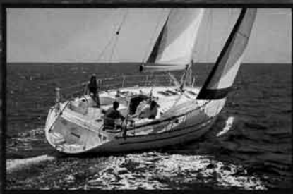
Парусная яхта BAVARIA-47 (Германия) полная длина 14,68м, длина корпуса 14,35м, длина по ватерлинии 11,45м, ширина на миделе 4,45м, осадка 2,00м (бульбашкиль..1,65м), высота мачты от уровня ватерлинии 19,40м, водоизмещение 7900кг, запас воды 480л, запас топлива 230л Цена от 193.268 евро
