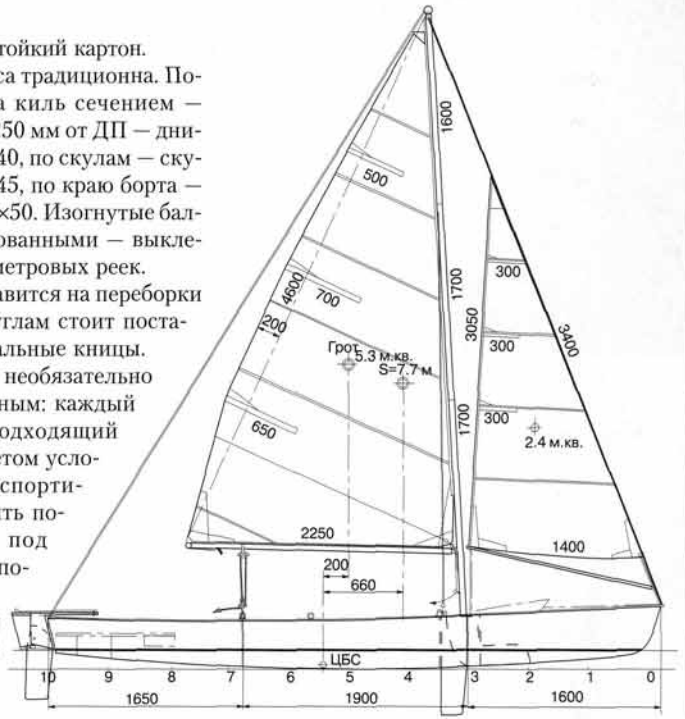
Общий вид однокорпусной секционной лодки с парусным вооружением ("КиЯ" №76).
