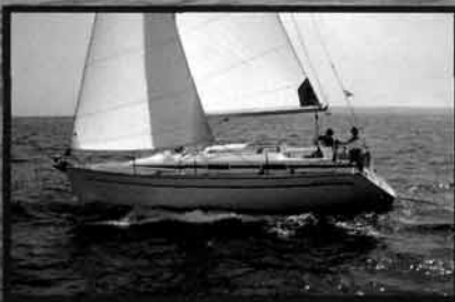
Парусная яхта BAVARIA-31 (Германия) полная длина 10,00м, длина корпуса 9,55м, длина по ватерлинии 8,25м, ширина на миделе 2,99м, осадка 1,75м (бульбашкиль..1,25м), высота мачты от уровня ватерлинии 13,27м, водоизмещение 4500кг, запас воды 150л, запас топлива 150л, двигатель 19 л.с. Цена от 54.920 евро
