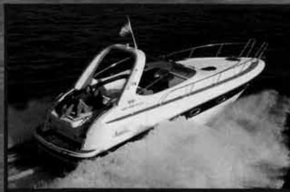
Моторная яхта BMB 300 sport (Германия) длина 9,45 м, ширина 2,98 м, высота от ватерлинии 2,78 м, высота в кают-компани 1,90 м, осадка 0,85/0,58 м, водоизмещение 4250 кг, объем топливного бака 750 л, объем бака для питьевой воды 150 л, вместимость 8 чел., мощность двигателя от 1x315 л.с., максимальная скорость 85-90 км/ч Цена от 79.206 евро
