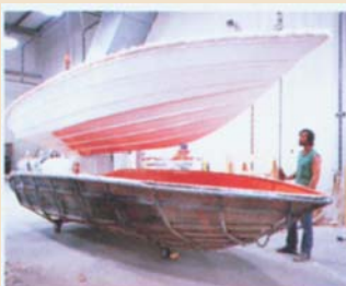
Рис. 6. Съем готовой секции с матрицы
