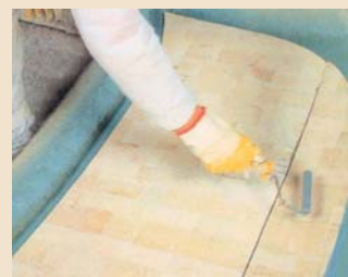
Рис. 5. Прикатка ламината на бальзовом наполнителе
