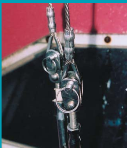
Рис. 7. Обжимная гильза и коуш на стальном тросе – предметы особого внимания
