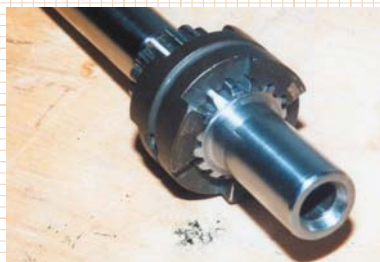
5. Храповик реверса и гребной вал
