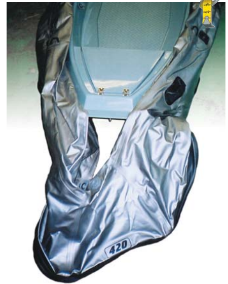
Съемный баллон, крепящийся на соединении “ликтрос—ликпаз” — один из наиболее значимых плюсов “420-го”.
