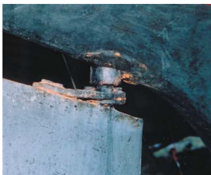
Рис. 1, 2. Узлы выхода баллера из корпуса
