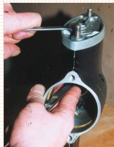
1. Чтобы отжать наверх обойму роликового подшипника, можно использовать технологическую крышку-заглушку с просверленным отверстием
