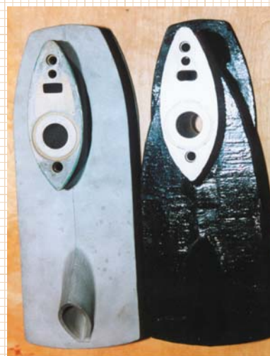
Слева — нижняя часть дейдвуда выпуска 1974 г., справа — 2000 г. Что изменилось? Конфигурация антикавитационной плиты и... качество наружных поверхностей
