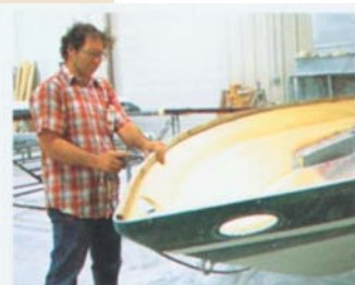
Рис. 7. Обрезка и сборка секций
