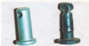
7. Валик верхней тяги реверса работает в агрессивной среде и быстро изнашивается.
