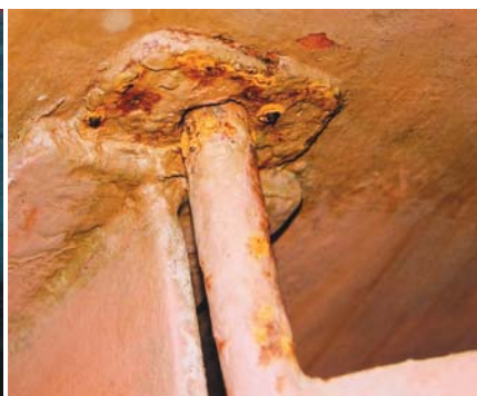
Рис. 3. Оковка пятки руля. Хорошо видны следы коррозии
