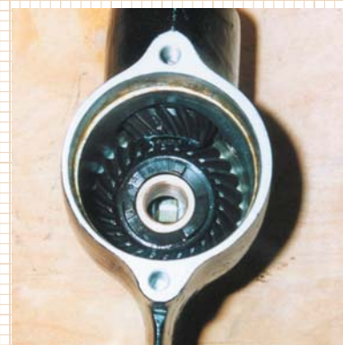
3. Торцевые внутренние поверхности шестерен должны совпадать
