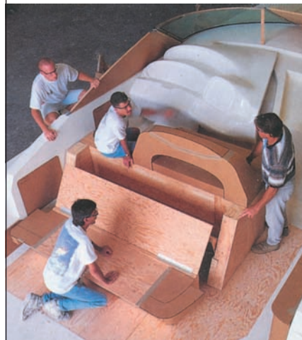
Полномасштабная модель — ключевой элемент всего процесса, гарантирующий высочайшее качество оборудования катера
