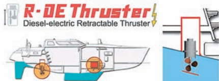
Рис. 7. Выдвижная подруливающая колонка “R-DE”, обеспечивающая поперечный упор
