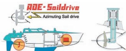
Рис. 8. Выдвижная пропульсивно-рулевая колонка “RA-DE” с азимутально изменяемым направлением упора
