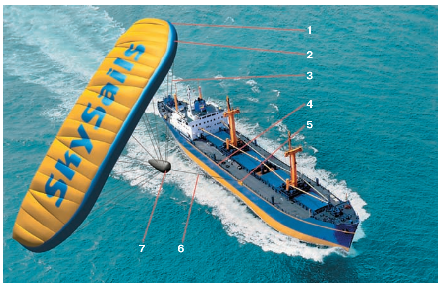
Рис. 1. Состав комплекса “SkySails”.
