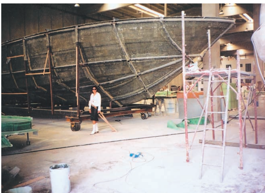
В такой матрице выклеивается корпус яхты "Aicon 56"
