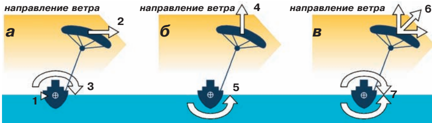
Рис. 3. Система "SkySails" и кренящий момент, создаваемый ею: а — кренящая составляющая; б — компенсирующая составляющая; в — баланс сил. 1 — ось вращения; 2 — кренящая сила; 3 — кренящий момент; 4 — подъемная сила; 5 — компенсирующий момент; 6 — результирующая сила; 7 — взаимная компенсация сил.
