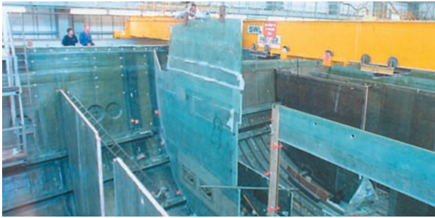
▲ Установка поперечных переборок в корпусе
