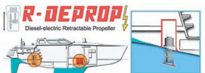
Рис. 6. Выдвижная пропульсивная колонка “R-DE PROP” с фиксированным направлением упора
