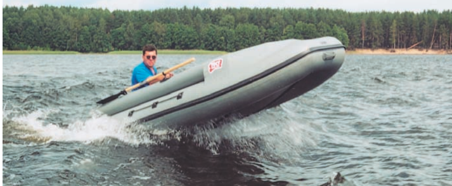
При малой нагрузке лодка выходит на глиссирование со значительным дифферентом
