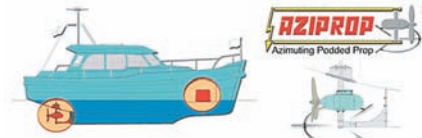
Рис. 9. Пример практического использования привода "AZIPROP", установленного в кормовом подзоре крупного водоизмещающего катера
