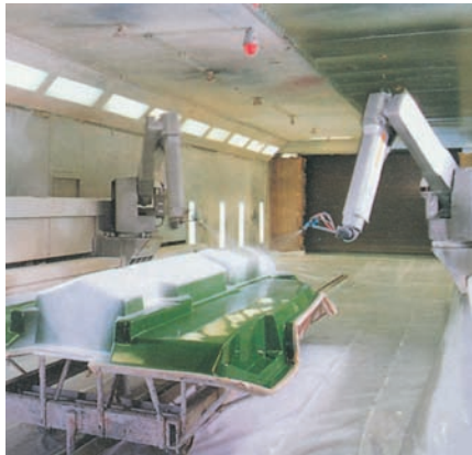
Робот наносит гелевое покрытие
