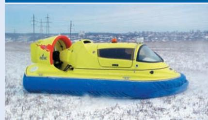
**ОСНОВНЫЕ ДАННЫЕ:** длина и ширина габаритные — 5.33×2.08 м; высота габаритная — 1.42 м; снаряженный вес — 350 кг; скорость движения, км/ч: по воде — 70, по снегу (льду) — 90, по грунту — 60; расход топлива на 100 км, л: нормальный — 16, максимальный — 20; емкость топливных баков — 80 л; материал корпуса — стеклопластик; пассажировместимость — 5 чел.
