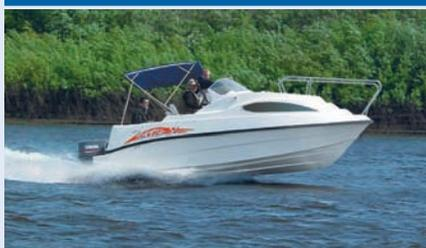
**ОСНОВНЫЕ ДАННЫЕ:** длина и ширина габаритные — 6.03×2.25 м; высота борта на миделе — 1.21 м; высота транца — 0.63 м; вес полностью укомплектованного катера (с предметами снабжения, ПМ и запасом топлива) — не более 1480 кг; грузоподъемность (пассажиры и полезный груз) — 750 кг; пассажировместимость — 6 чел.; объем топливного бака — 200 л; допустимая мощность ПМ — 150 л.с.
