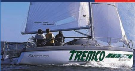
Гоночно-круизная трейлерная лодка нового поколения. Изготовлена по Hi-Tech из углепластика весом 800 кг. Имеет подъемный киль с амортизатором. Непотопляема. Высокая скорость для гонок, простота управления для воскресного отдыха 3-4 человек - идеальное сочетание для 28 футовой лодки. Производство Финляндия.
