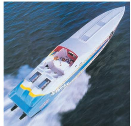
Типичная американская спортивная яхта “Innovator” (“Nor Tech 380”). Размерения — 11.4х2.44 м; водоизмещение порожнем — 3.85 т; мощность двигателей, работающих на две колонки, 2х588 кВт; скорость — около 85 уз. Яхта оборудована каютой на три койки, камбузом и санузлом
