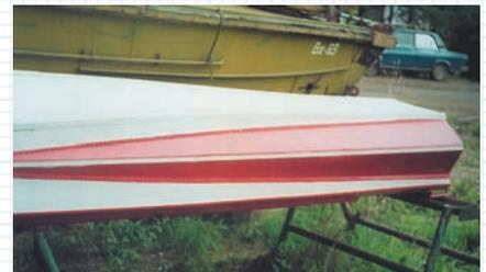
Рис. 6. Подъем килевой линии в носу лодки “ПК-5”
