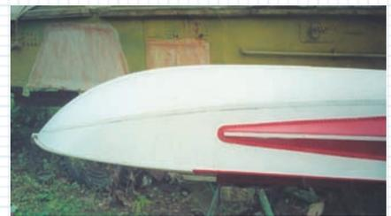
широкой кормы по скуле. На больших скоростях это приводит к лишней смоченной поверхности и увеличению сопротивления, на малых — к замыканию бортов судна смыкающимися боковыми потоками воды, образующегося вокруг корпуса судна при его движении водяного “корыта”. Наилучшая ширина — 70–85% наибольшей ширины по скуле.
