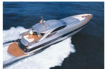
Скоростная моторная яхта “Pershing 88” фирмы “Pershing” (группа “Ferretti”, Италия). Размерения — 26.96х6.23х1.65 м; водоизмещение — 56 т; мощность двигателей — 2х1345 кВт; скорость — 39 уз
