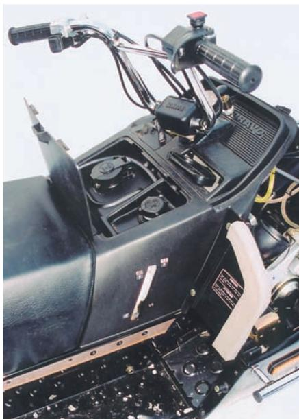
Горловины дополнительного бензобака и масляного бачка — под крышкой на панели. Ниже — трубки контроля уровня бензина и масла.
