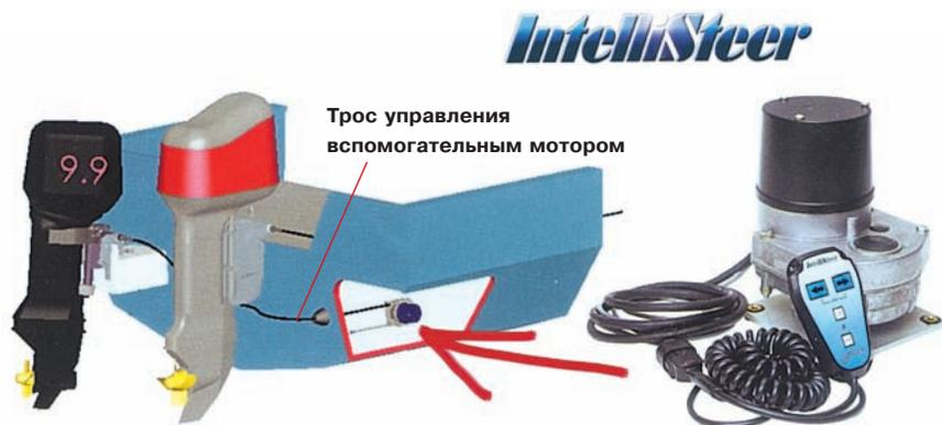
Рулевой редуктор с электроприводом
