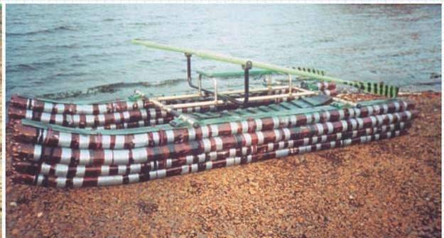
средство: 160 бутылок общим объемом около 360 л обеспечивают необходимый запас плавучести. Ни разрушений бревен, ни порезов бутылок не было. Несмотря на небольшую толщину стенок (0.27 мм) бутылки за навигацию практически не износились.
