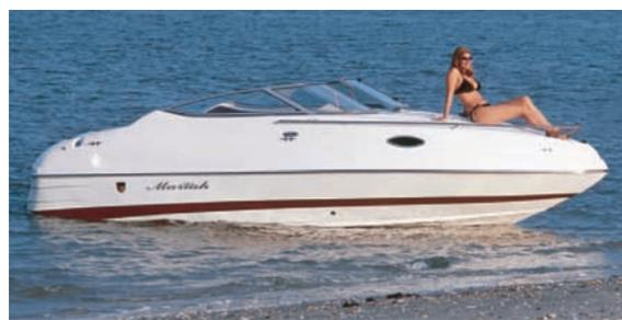
**Одна из наиболее удачных моделей — универсальная 10-местная “Mariah SC 21”. Длина — 6,2, ширина — 1,95 м. Грузоподъемность — 815 кг при водоизмещении 1500 кг. Килеватость — 20°. При мощности силовой установки 190 л.с. — скорость до 71 км/ч, при 250 л.с. — 88,5 км/ч.**
