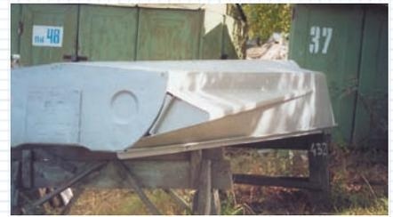
Рис. 5. Нижняя кромка буля на “ПК-5” (“Обь”) резко поднимается от транца к миделю вместе со скулой. Нижняя грань идет резко вверх от борта.
