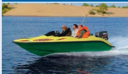
**ОСНОВНЫЕ ДАННЫЕ:** длина и ширина габаритные — 4.34×2.14 м; высота борта на миделе — 0.84 м; высота транца — 0.51 м; масса корпуса — не более 320 кг; грузоподъемность (пассажиры и полезный груз) — 450 кг; пассажировместимость — 4 чел.; допустимая мощность ПМ — 90 л.с.
