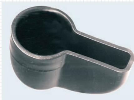
Рис. 1. Такая пластмассовая насадка, надеваемая на карбюратор, препятствует попаданию воды в диффузор
