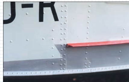
Пример отделки бортов "Казанки-2М" эмалью ПФ-115: слой пентафталевого грунта ПФ-0224 и три слоя эмали
