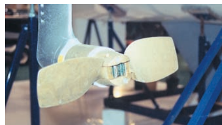
10. При выключении двигателя парусной яхты гребной винт автоматически "складывается" во флюгерное положение
