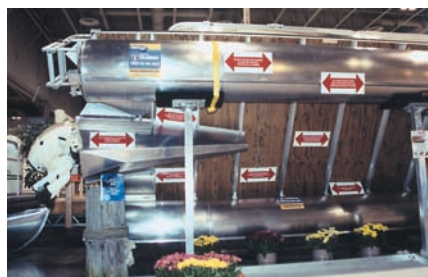
12. Вид снизу на простейшее понтонное судно с легкосплавными поплавками
