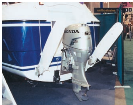
14. Рули подняты. Лодка идет как быстроходная моторная с 50-сильным четырехтактником. Если торопиться некуда, можно поставить паруса.
