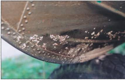
“Звездное небо” — корродированная носовая часть “Казанки-5”
