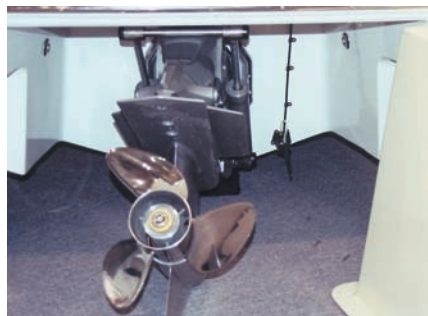
5. Установка движителя в выштампованном кармане-рецессе, справа виден датчик скорости
