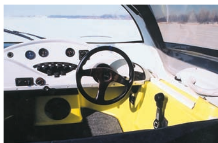
Салон “Пегаса” очень напоминает автомобильный. Двери откидываются вверх и фиксируются газонаполненными стойками. Сиденья довольно простенькие, но в разложенном виде образуют идеально ровную широкую лежанку.
