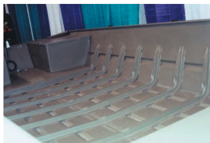
1. 2. Лодка не из дорогих — с упрощенными обводами. Сваривающийся легкий сплав, гофры на обшивке, приварные коробчатые шпангоуты. Баки плавучести выполняют роль сидений.
