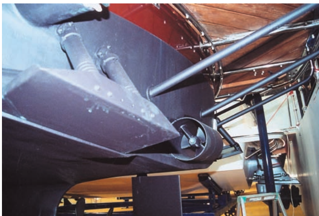
В любом японском катере на первом месте — надежность. Двигатель “запрян” под кормовым подзором. Катера оборудуют носовым и кормовым подруливающими устройствами.
