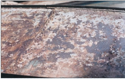
Корпус “Прогресса-2”, крашенный чем попало и как попало. Вдоль киля — темное пятно большой площади — это развитая коррозия, требующая “хирургического” вмешательства.
