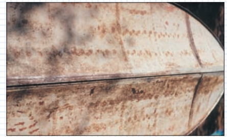
Мой любимец “Прогресс-2” с днищем, покрытым 20 лет назад краской ЭП-111. Хорошо видны промежуточные подмазки эпоксидной смолой клепанных швов в период эксплуатации
