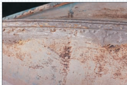
Повреждения эпоксидного слоя автомобильной шпаклевки с алюминиевой пудрой на носовой части «Прогресса-2» — дюралюминий корпуса не пострадал
