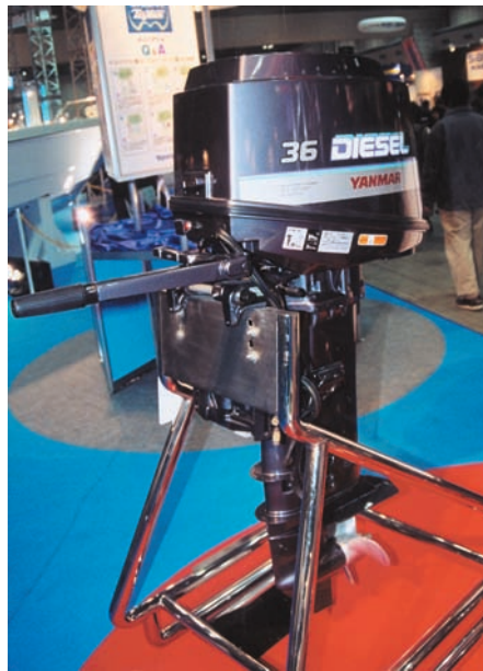
36-сильный дизельный подвесной мотор широко известной своими дизелями фирмы "Yanmar"
