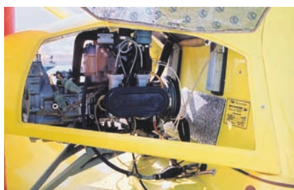
Моторный отсек, в котором установлены двухтактный "Rotax" и аккумулятор, закрыт обтекателем. Доступ к двигателю великолепный — достаточно откинуть боковые капоты. Выхлопная труба защищена от снега и брызг асбестовой обмоткой.
