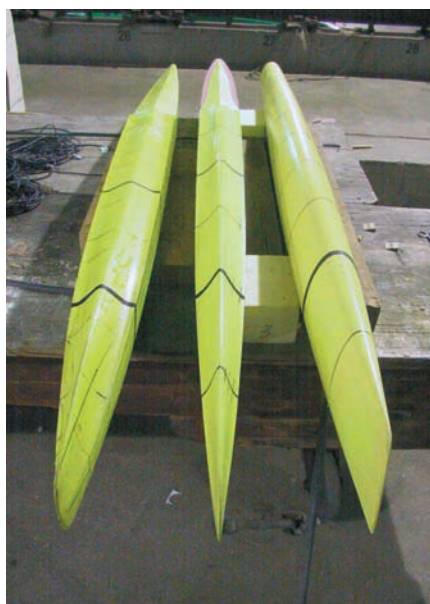
Для испытаний в бассейне подготовили три разных корпуса
