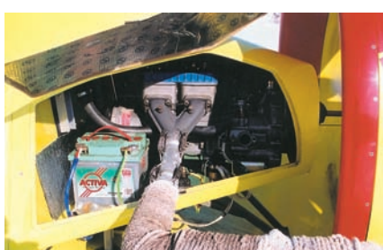
Моторный отсек, в котором установлены двухтактный "Rotax" и аккумулятор, закрыт обтекателем. Доступ к двигателю великолепный — достаточно откинуть боковые капоты. Выхлопная труба защищена от снега и брызг асбестовой обмоткой.
