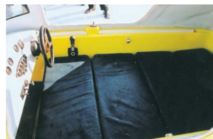
Салон “Пегаса” очень напоминает автомобильный. Двери откидываются вверх и фиксируются газонаполненными стойками. Сиденья довольно простенькие, но в разложенном виде образуют идеально ровную широкую лежанку.
