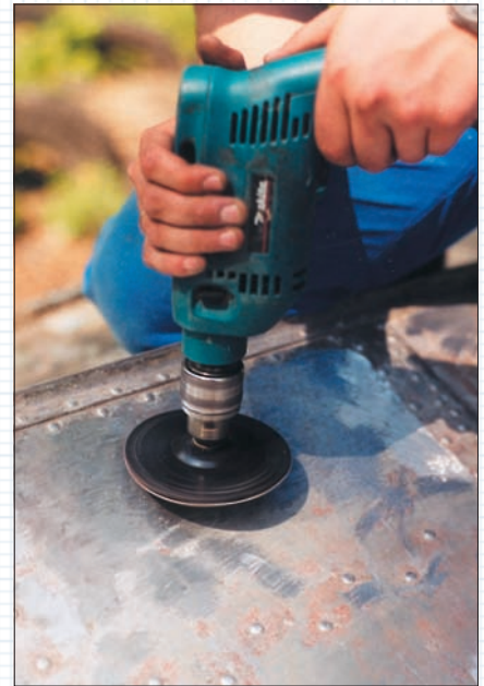
Способ зачистки больших площадей корпуса, поврежденных коррозией, перед травлением ортофосфорной кислотой в смеси с водой в соотношении 1:1
