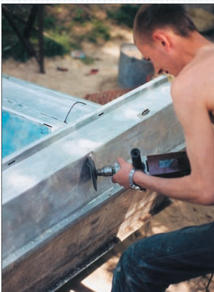
Пример грубого невежества и технической безграмотности — снятие плакирующего покрытия — защитного слоя дюралюминия
