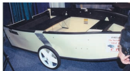
13. Складная полипропиленовая лодка мирового класса — так написано на рекламном плакате. Колеса не только облегчают перемещение этой и без того легкой лодки, но и намекают на возможность использовать ее как тележку.
