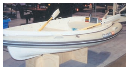
15. Этот тузик делали высокие профессионалы. На пристегивающемся баллоне — ручка; значит, нет сомнения в прочности ни самого баллона, ни крепления его к корпусу.
