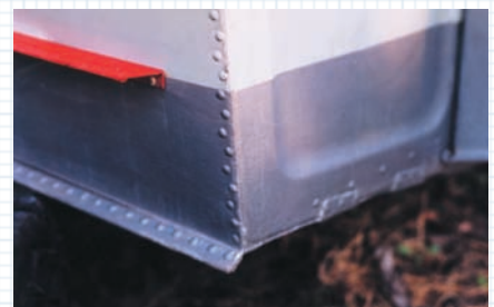
Уровень защиты транца и бортов четырехслойным эпоксидным “сэндвичем” из автомобильной эпоксидной шпаклевки
