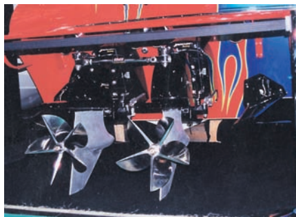
4. Суперкавитирующие полупогруженные винты быстроходного катера
