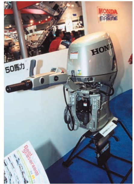
Новая "Honda" с выведенными на румпель датчиками давления и перегрева двигателя и управлением триммером
