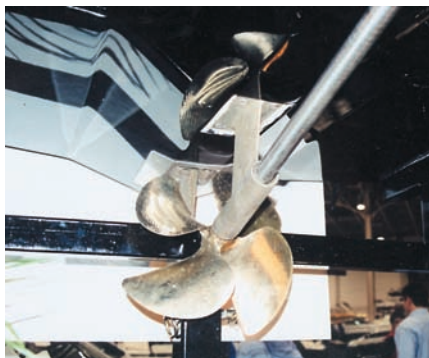
9. Винт с мелкой концентрической волновидной накаткой
