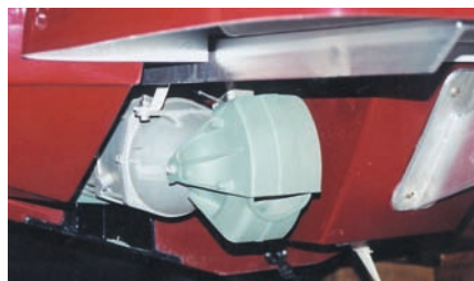
11. Установка водомета в пределах габарита корпуса
