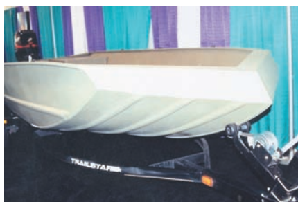
1. 2. Лодка не из дорогих — с упрощенными обводами. Сваривающийся легкий сплав, гофры на обшивке, приварные коробчатые шпангоуты. Баки плавучести выполняют роль сидений.
