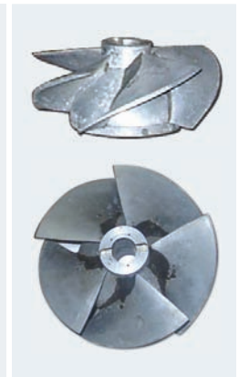
Рис. 3. Недиффузорная модель рабочего колеса — импеллера МГВД
