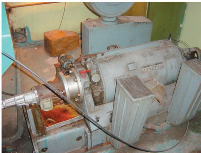
Рис. 7. Мотор на испытательном стенде с ЭТУ
