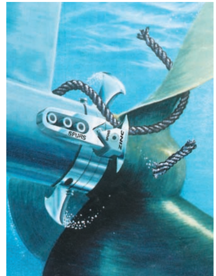
Рис. 9. Ножи для гребного винта особенно оценят любители плаваний в заросших водоемах вроде Саргассова моря
