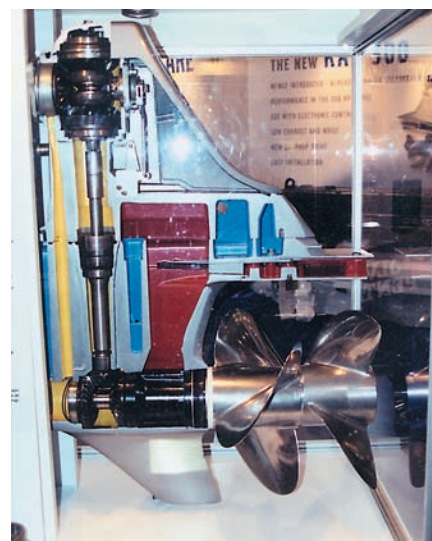
Рис. 1. “Препарированная” колонка изобретателя установки “Дуо-Проп” с двумя винтами шведской фирмы “Вольво Пента”
