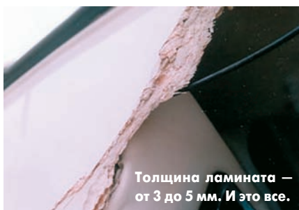
Еще одно свидетельство низкой прочности соединения наружного слоя и заполнителя из шпатлевочной массы
