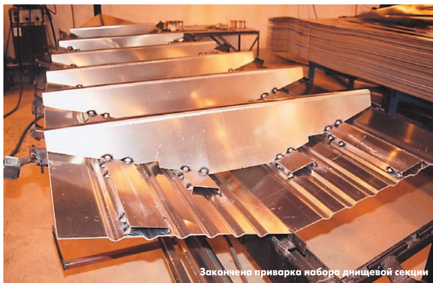
Ручная сварка в кантователе — приварка прерывистым швом некладных реданов
