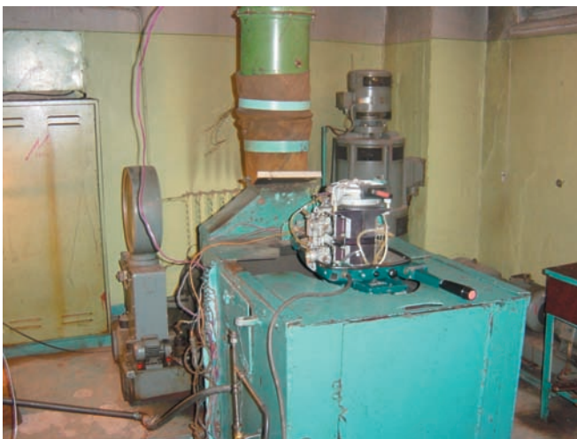
Рис. 7. Мотор на испытательном стенде с ЭТУ
