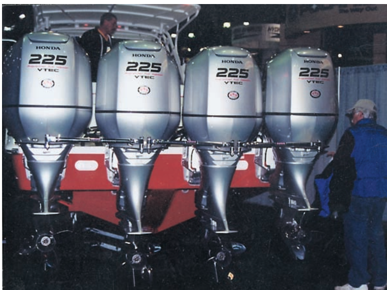
Рис. 4. Четыре этих “Хонды” весят около 1100 кг плюс оборудование. Корма предельно низка. На корме сделан подзор для улучшения обтекания винтов.
