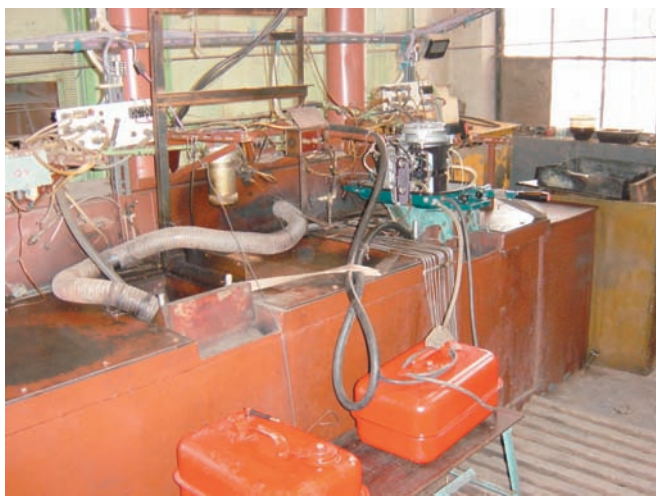
Рис. 3. Обкатка на гидрованне
