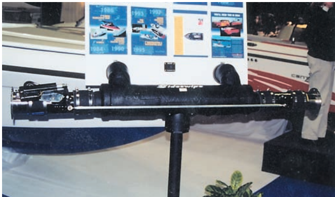
Рис. 7. Перераспределитель выпускных газов с борта на борт
