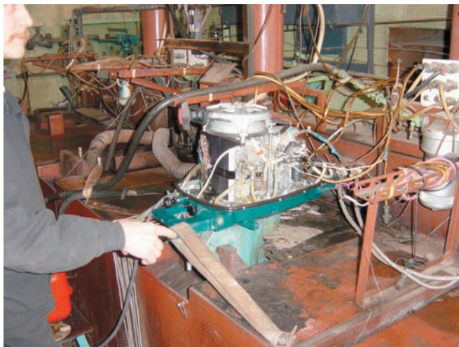
Рис. 6. Мотор подсоединен к ЭТУ
