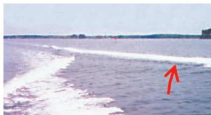
Кильватерный след испытываемой самоходной модели на полном ходу. Снимок сделан с идущего параллельным курсом глиссирующего катера.
