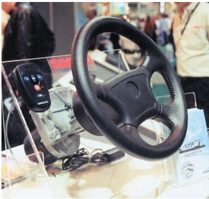
Рис. 8. Электроусилитель руля с дистанционным управлением снижает утомляемость в дальнем походе и облегчает маневрирование в узкостях в одиночку. Осталось только снабдить таким дистанционным усилителем управление газом и реверсом.
