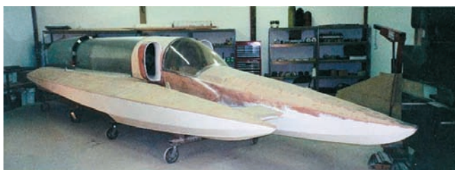
Глиссер "Spirit of Australia" в процессе модернизации перед рекордным заездом. Предстоит установка кормового крыла-стабилизатора. Длина корпуса — 8,42 м.
