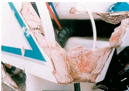
После удара отвалилась площадка 30-футового катера. Посмотрите и на пролом в скуле внизу слева. При таком запасе прочности один человек может превратить этот катер в груды мелких обломков, действуя одним только молотком. Обратите внимание, что на всех разрушениях отчетливо заметно полное отсутствие стекловолоконного армирования.
