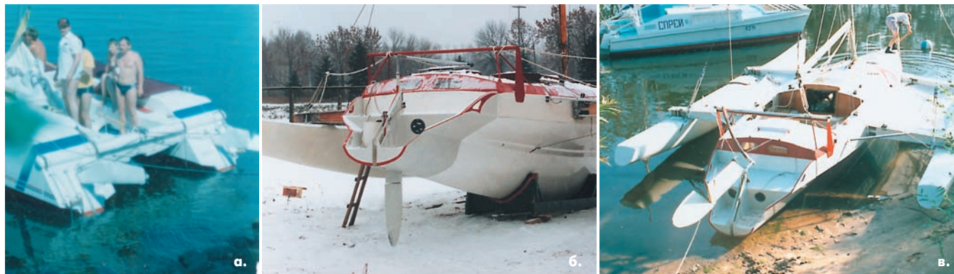
Рис. 1. а. Поднятые рули при стоянке на мелководье; б. Положение руля в рабочем состоянии перед спуском на воду; в. Поднятый руль при стоянке судна на пляже
