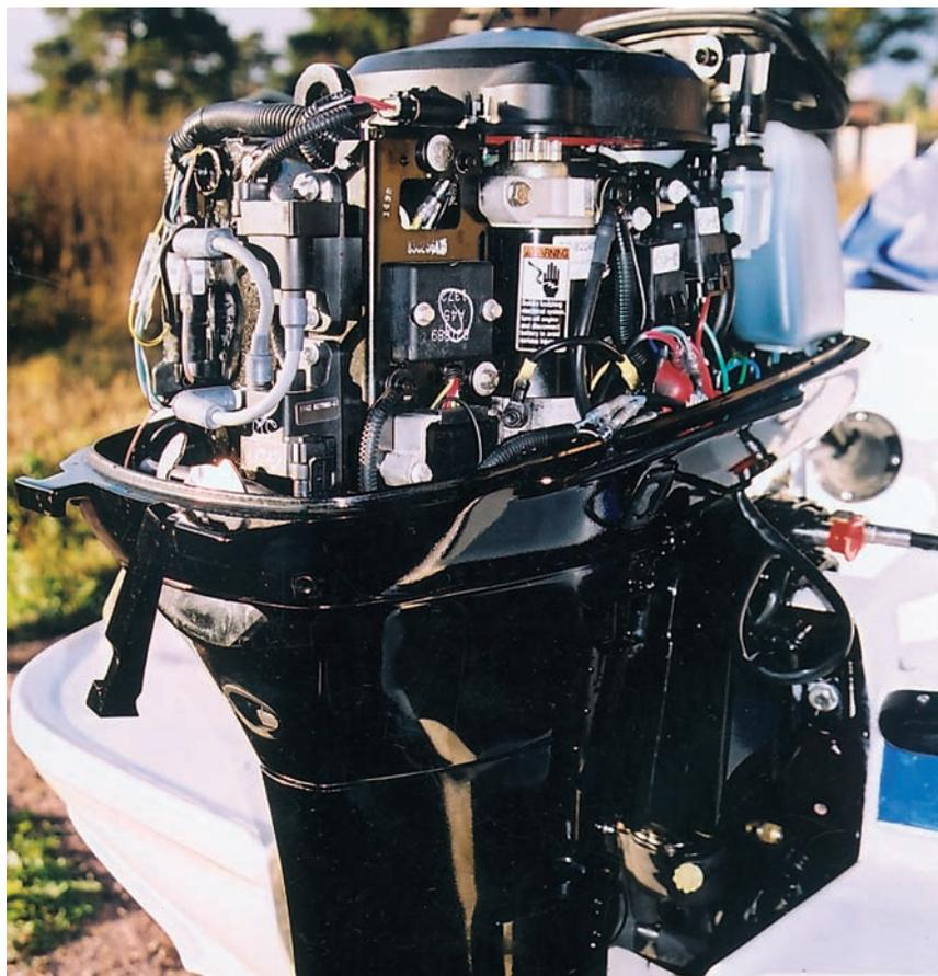
Узлы электрооборудования мотора сосредоточены в основном в правой части двигателя
