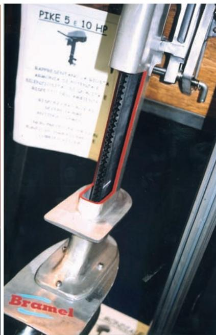
Подвесной электромотор фирмы «Bramel». Справа — демонстрационный экспонат с вырезом в дейдвуде. Хорошо виден зубчатый приводной ремень.
