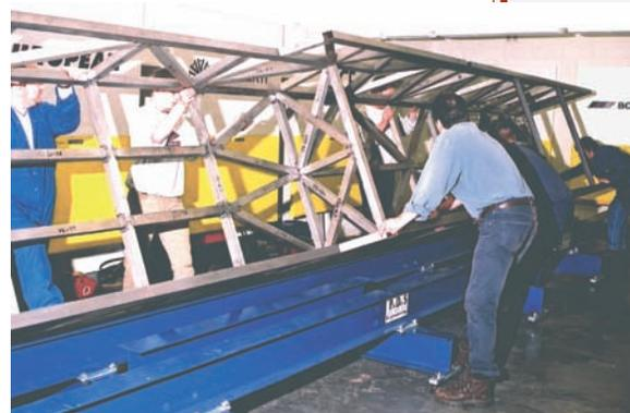
Сварная ферма, имитирующая силовую каркас рекордного глиссера, поступает на стэнд для испытаний прочности
