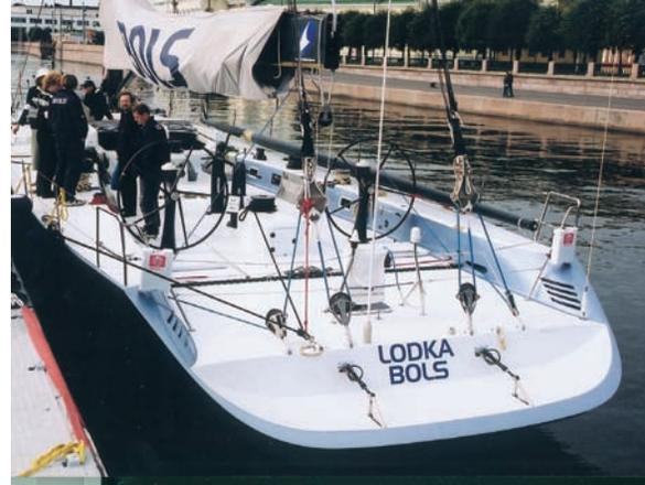
**Корма яхты.** На кринолине видны гидроприводы транцевых плит. Продольные прорезы на комингсе кокпита предназначены для аварийного слива самотеком водяного балласта.
