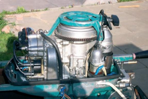
Рис. 9. Расположение новой бобины зажигания
