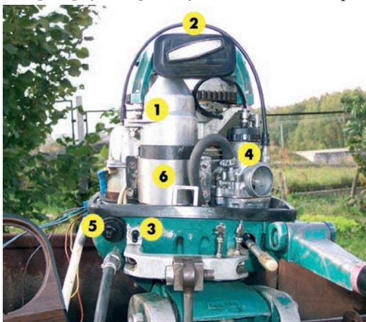
Рис. 3. Расположение стартера и карбюратора на двигателе
