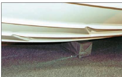
**Рис. 2.** Такие наклонные уступочки между ПР первого типа вторят линии форштевня и как бы сопровождают их; их высота почти равна высоте ПР.
