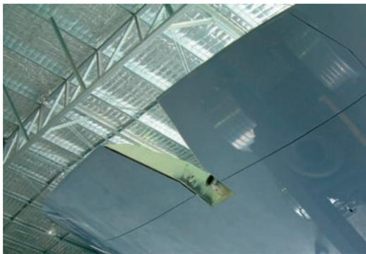
**Транцевые плиты.** Вид снизу. В середине — вырез в транце для установки аварийного руля.
