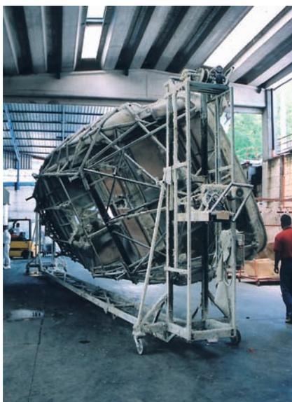
Закрепленную в кантователе матрицу закатывают в цех для нанесения гелькоута
