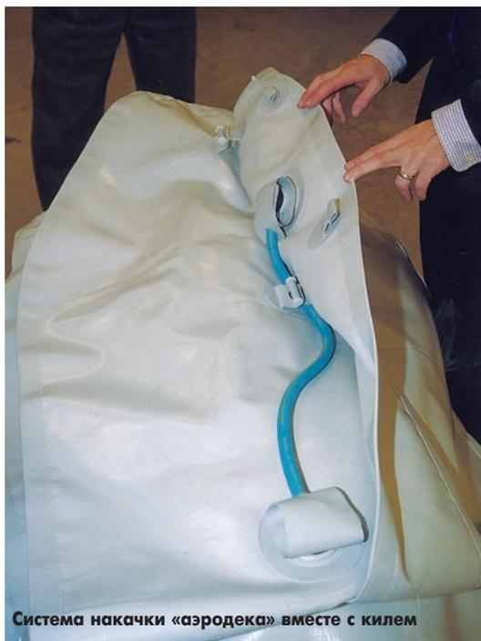
Система накачки «аэродека» вместе с килем
