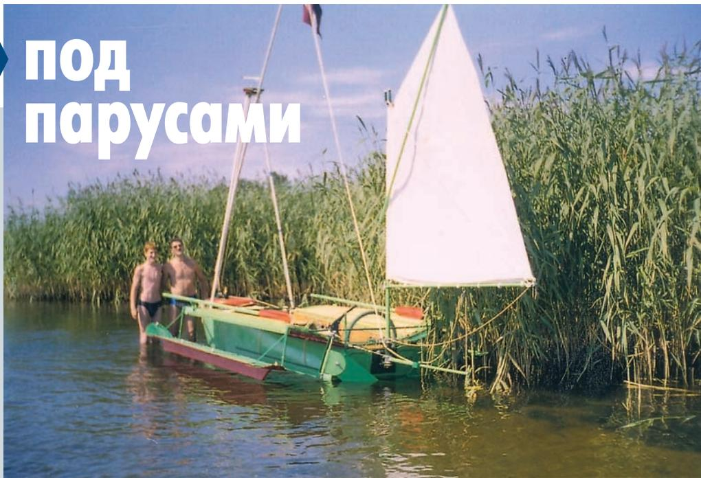
ется не сорлинем, а рычагами ручных тормозов легковых автомобилей. Рулевое колесо (внутри рабочего отсека) — на корме, выполнено из переднего колеса от велосипеда диаметром 60 см, шкивы, трос обеспечивают поворот спаренных рулей в диапазоне 0–50°.
