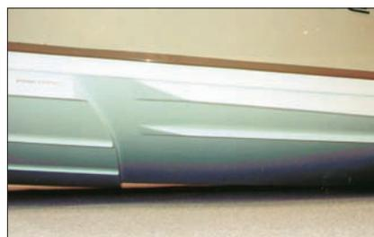
**Рис. 3.** ПР второго типа проще в изготовлении, хотя менее выразителен, но свое дело знает. Здесь также ограничили себя двумя продольными ребрами до поперечного и одним продольным после него.
