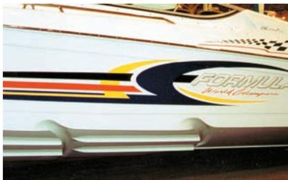
**Рис. 6.** Два ПР на одном из самых быстроходных катеров. Отсутствуют продольные реданы после второго поперечного.
