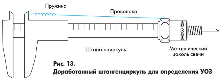
Рис. 13. Доработанный штангенциркуль для определения УОЗ
