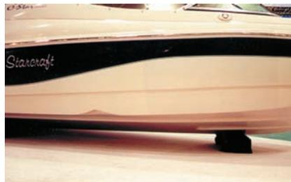
**Рис. 8.** На катере компании «Starcraft» использован дополнительный подвод воздуха под скулу – еще не ПР, но все же полезное дополнение
