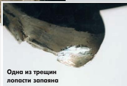
Одна из трещин лопасти запяна
