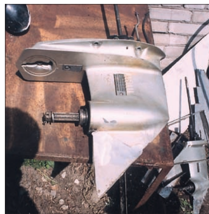
Наварка отломанного пера — вполне рутинное дело для ремонтных мастерских
