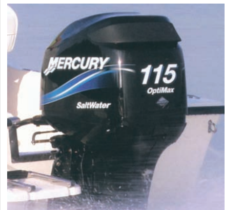
На транце легкой мотолодки новинка от "Mercury": 115-сильный двухтактный "OptiMax" с непосредственным впрыском топлива в камеру сгорания
