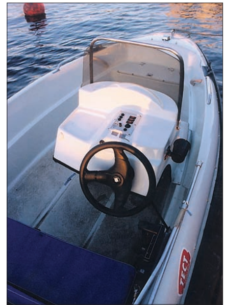
На более поздних версиях “Бриза” консоль дооборудована герметичным бардачком и держателем-подстаканником
