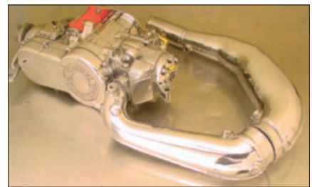
Рис. 3. Большое внимание было уделено настройке выхлопной системы и снижению шума. Корпусные детали мотора отлиты под давлением и с такой высокой чистотой поверхности, что кажется, будто их специально полировали.
