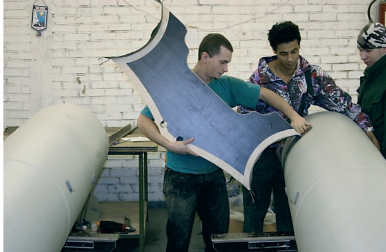
Установка транцевой доски - одна из самых ответственных операций при сборке
