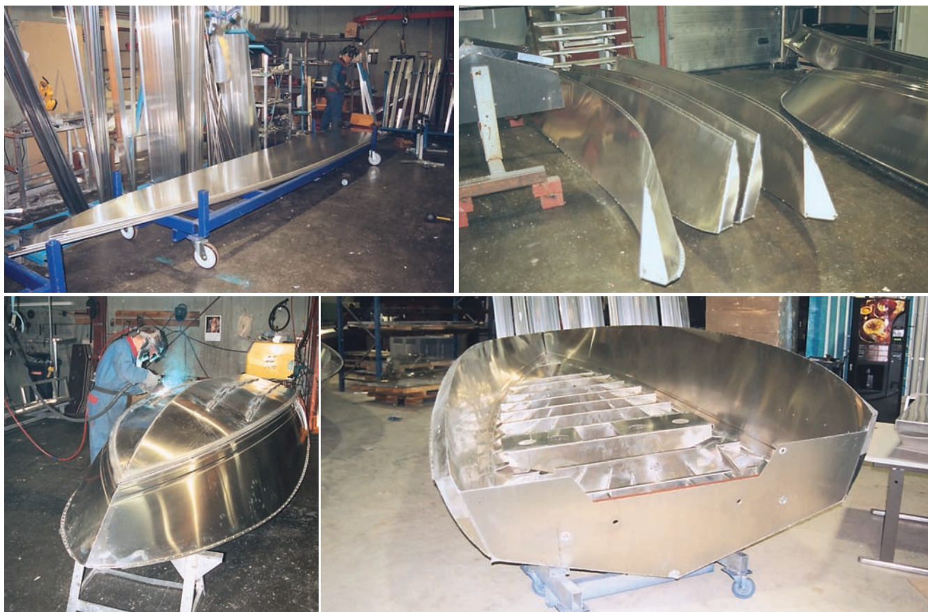
Идеально раскроенные алюминиевые листы образуют сначала бортовые секции-призмы, затем заготовки свариваются в металлические корпуса "Silver"
