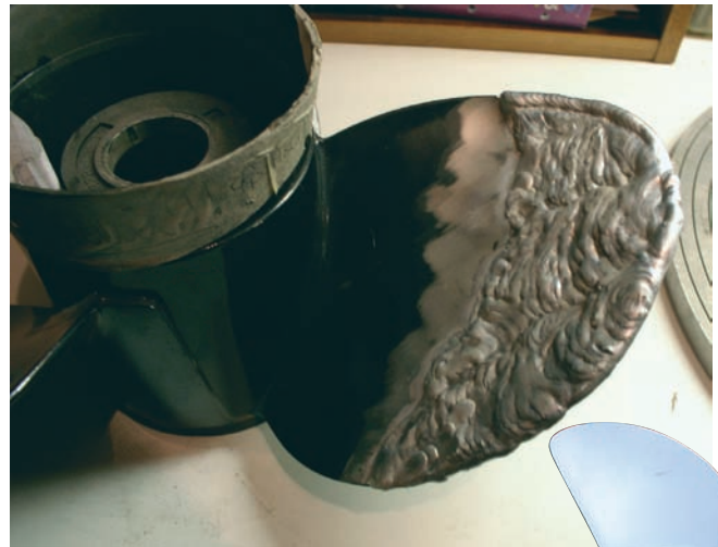
Наплавка недостающей части лопасти в чем-то сродни работе скульптора
