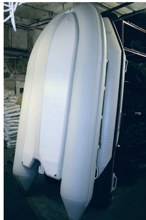
Модель с днищем "аэродек" — новый подход к конструированию надувных лодок
