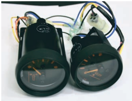
Рис. 7. После 2001 г. “Yamaha” немного изменила конструкцию указателя. Внешне их легко отличить по числу проводов передачи данных и длине корпуса (“новый” — справа)
