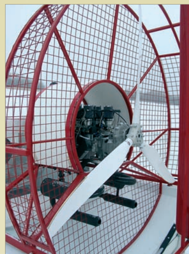
Силовая установка — 102-сильный впрысковый "Hirth"
