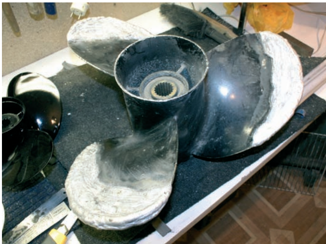
Наплавка недостающей части лопасти в чем-то сродни работе скульптора
