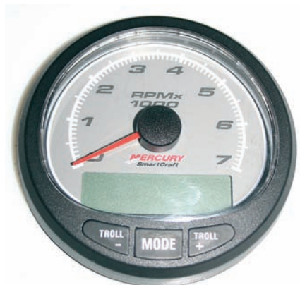
Рис. 6. Столбик, отражающий степень откидки мотора в “SmartCraft”, можно вывести не только на экран основного блока, но и на вспомогательный дисплей тахометра
