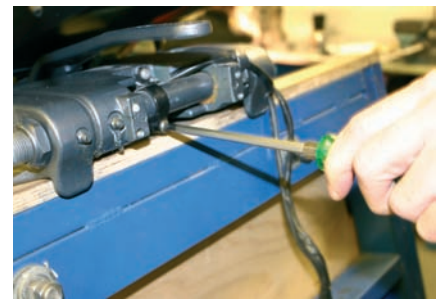
Рис. 9. На мощных моторах “Yamaha” регулировать датчик проще всего — к нему можно подобраться прямо из кокпита, не откидывая мотор
