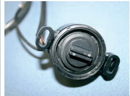
Рис. 4. Датчик триммера моторов “Mercury” заметно отличается на вид от японских. Овальные крепежные отверстия допускают регулировку в довольно широких пределах.
