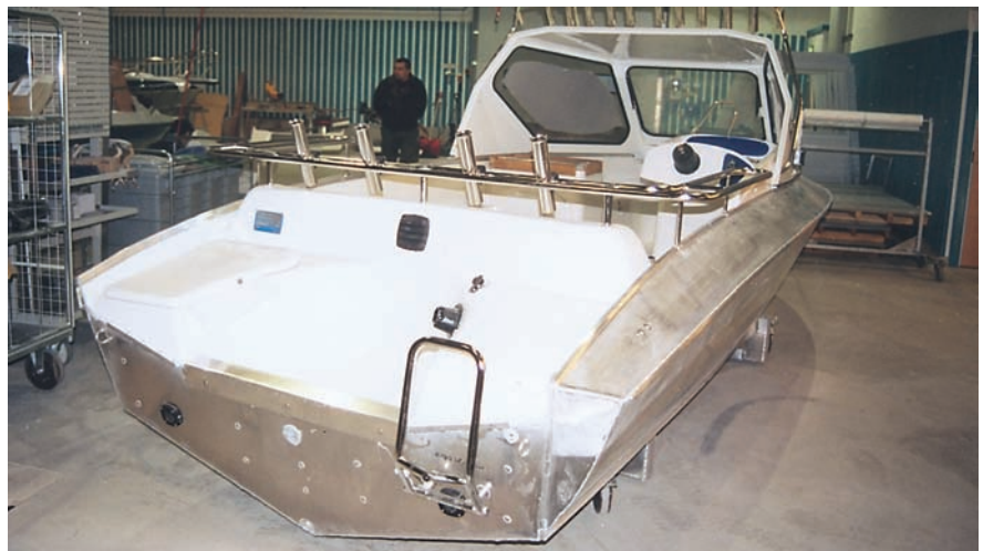
Установка пластиковой “ванны” — секции кокпита — превращает алюминиевый корпус в полноценную лодку
