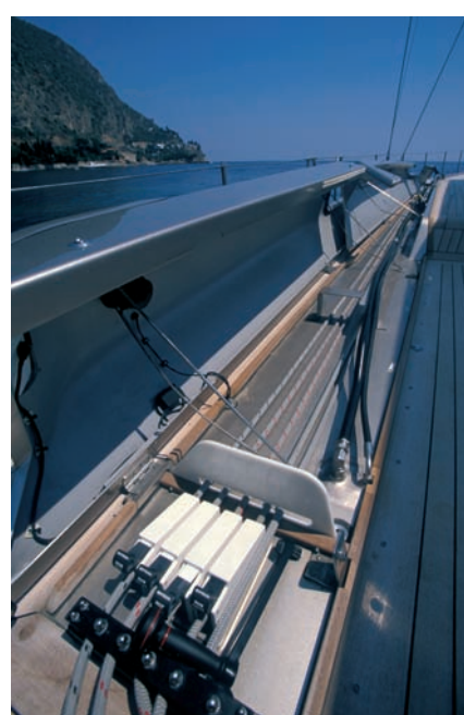
Откидывающиеся комингсы яхты скрывают под собой проводку бегущего такелажа
