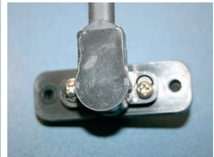
Рис. 5. Для цифровой системы “SmartCraft” на “Mercury” требуется специальный датчик, имеющий те же посадочные места, что и обычный
