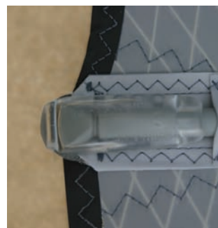
В отделке паруса применены современные высокопрочные пластики с хорошей сопротивляемостью ультрафиолету
