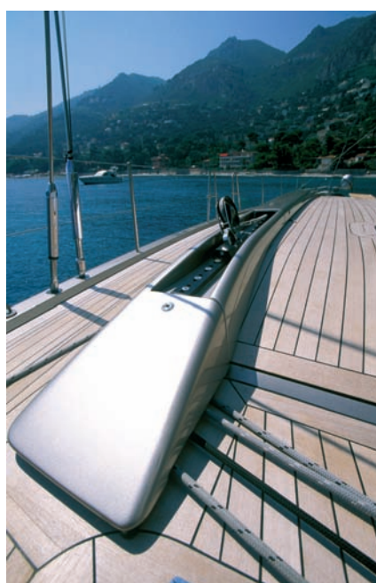
Откидывающиеся комингсы яхты скрывают под собой проводку бегущего такелажа
