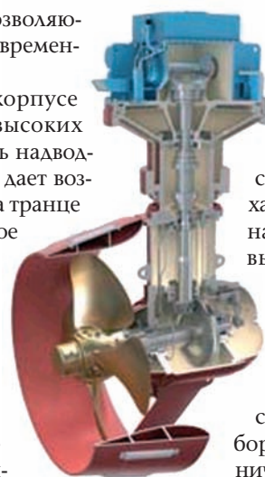
Азимутальный полноповоротный привод от корпорации «Rolls-Royce»
