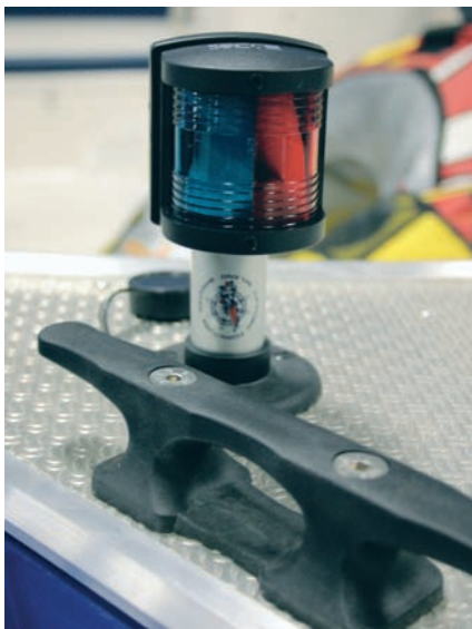
Для небольших лодок удобны бортовые огни, объединенные в одном корпусе
