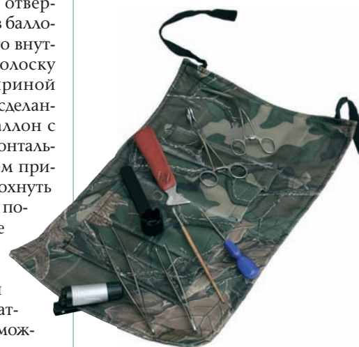
С таким набором инструментов можно профессионально ремонтировать баллоны лодок
