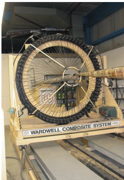
Процесс намотки углепластиковой мачты на верфи “Tartan Yachts”
