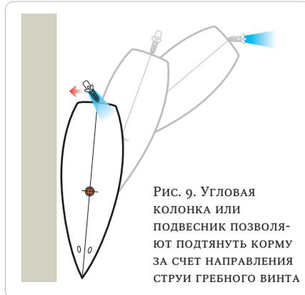
Рис. 9. Угловая колонка или подвесник позволяют подтянуть корму за счет направления струи гребного винта
