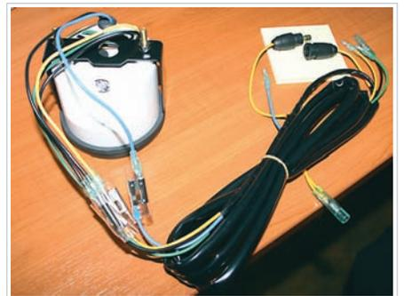
ТАХОМЕТР "YAMAHA" СНАБЖЕН ПРЕДОХРАНИТЕЛЕМ НА СЛУЧАЙ РЕЗКОГО СКАЧКА НАПРЯЖЕНИЯ — НАПРИМЕР, ПРИ ОТСОЕДИНЕНИИ АККУМУЛЯТОРА НА ХОДУ
