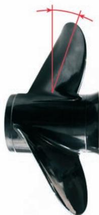
Рис. 3. Этот угол установки лопасти специалисты именуют “отборс”. С его помощью тоже можно сделать винт более “тяжелым” или “легким”, но откорректировать его, как и шаг, в домашних условиях достаточно сложно.
