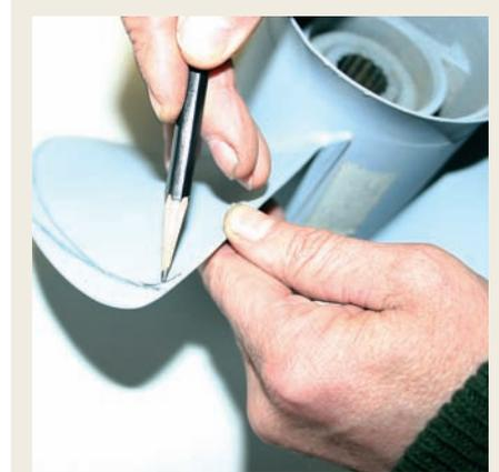
Рис. 5. Предварительная разметка лопасти при уменьшении диаметра винта. Особая точность тут не требуется — просто попытайтесь повторить в уменьшенном виде существующую конфигурацию.
