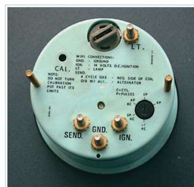
Тыльная сторона тахометра “MERCURY” (он же “TELEFLEX”). СПРАВА — селектор числа полюсов магдино.
