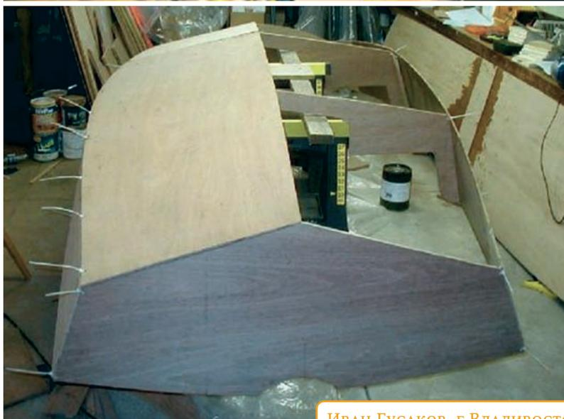
Рис.3. Листы обшивки сшиваются временными скрепками
