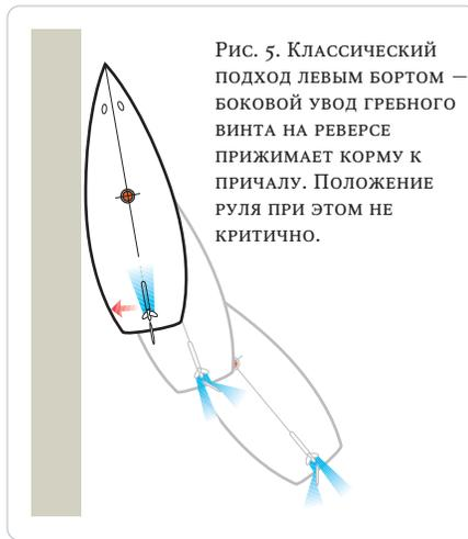
Рис. 5. Классический подход левым бортом — боковой увод гребного винта на реверсе прижимает корму к причалу. Положение руля при этом не критично.
