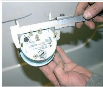
Практически все тахометры различных фирм имеют одинаковый диаметр корпуса — 86 мм
