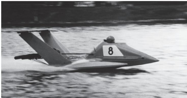
ГРИГОРИЙ ПЕТРОВ УПРАВЛЯЕТ "МС-08" — ПОСЛЕДНИМ ИЗ СЕРИИ ЭКРАНОПЛАНОВ ЦКТБ ДОСААФ СССР С ДВИГАТЕЛЕМ "KONIG", 500 см<sup>3</sup>, 1991 г.
