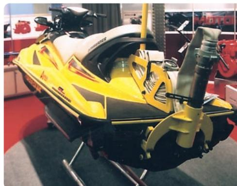
НЕОБЫЧНОЕ РЕШЕНИЕ КОНСТРУКЦИИ СЛУЖЕБНОГО ГИДРОЦИКЛА — ВОДОМЕТ РАБОТАЕТ НА ПОЖАРНЫЙ РУКАВ
