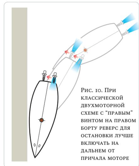
Рис. 10. При классической двухмоторной схеме с “правым” винтом на правом борту реверс для остановки лучше включать на дальнем от причала моторе
