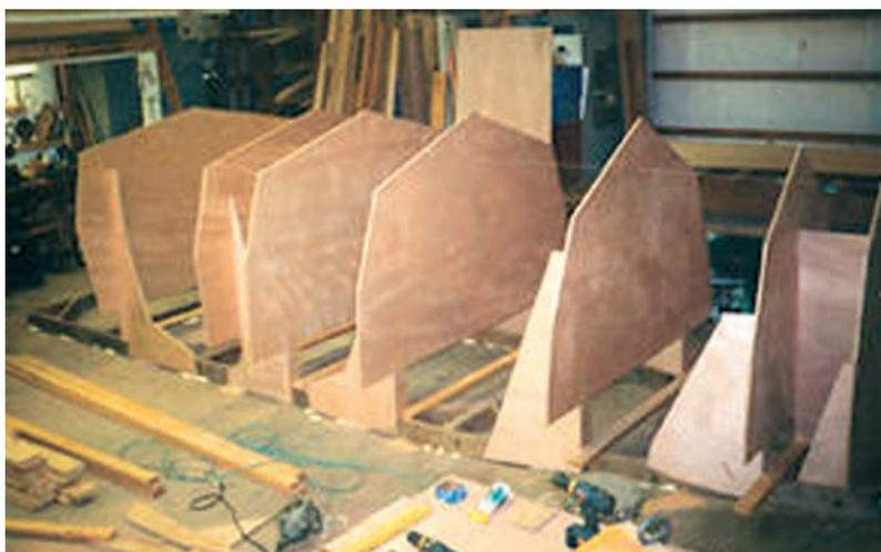
Рис.2. На стапельную раму выставлены фанерные шпангоуты, пока без необходимых вырезов
