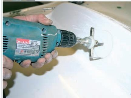
Корончатая фреза удобнее в использовании, но она дороже и не столь универсальна, как раздвижная. В крайнем случае можно использовать электролобзик или засверловку по контуру с последующей обработкой напильником.
