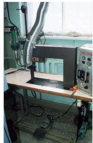
Новая машина для сварки ПВХ горячим воздухом пока работает в экспериментальном режиме
