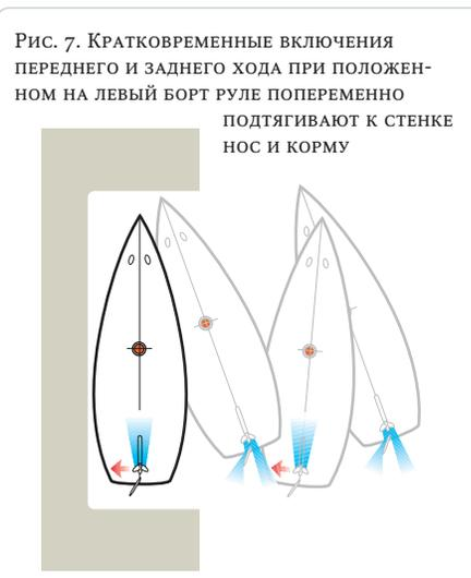
Рис. 7. Кратковременные включения переднего и заднего хода при положении на левый борт руля попеременно подтягивают к стенке нос и корму
