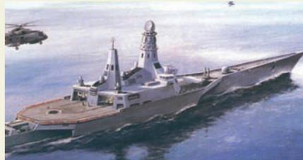
■ Статья Н. Корытова показывает неразрывную связь “малого” и “большого” судостроения: тримаранная схема катера, установившего рекорд кругосветного плавания, применяется при постройке все более крупных судов и кораблей ВМФ.
