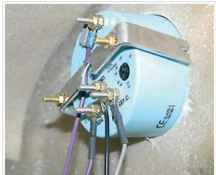
Фиксируем прибор изнутри накладной планкой. Если толщина планки более 13 мм, концы крепежной планки придется подрезать напильником или ножовкой.
