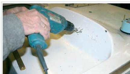
Сверлим отверстие под ось фрезы по центру окружности
