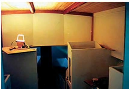
Отсутствие частого поперечного набора, особенно бимсов, делает помещения просторнее
