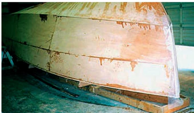
Рис.4. Сшитый и проклеенный корпус готов к отделке
