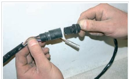
Соединяем разъемы жгута и машинки газа-реверса
