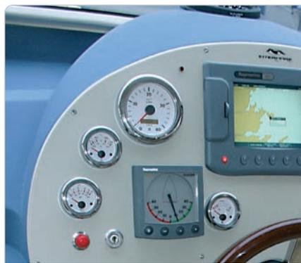
Рис. 6. Указатель положения рулевого пера или угловой колонки — очень полезная вещь при маневрах в тесной гавани. Перед отходом от причала взглянуть на него тоже полезно.
