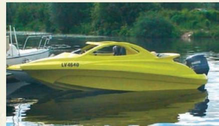
■ Знакомим читателей с очередной любительской реализацией популярной “Радуги-34” Ю. Зимина с корпусом, построенным по нечасто применяемой в самострое технологии — оклейкой стеклопластиком пенопластового формозадающего пуансона, выполняющего далее роль заполнителя трехслойной конструкции.
