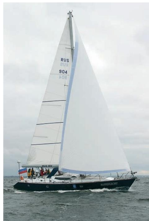
\* Как считает конструктор, такое поведение яхты есть следствие ее большой инерционности, в силу чего она медленнее реагирует на переладку руля и требует предугадывать ее реакцию на волну раньше, чем на более легких яхтах.
