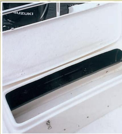
Аккумулятор перекечевал из кормового рундука в бортовой отсек кокпита, подальше от бензобака
