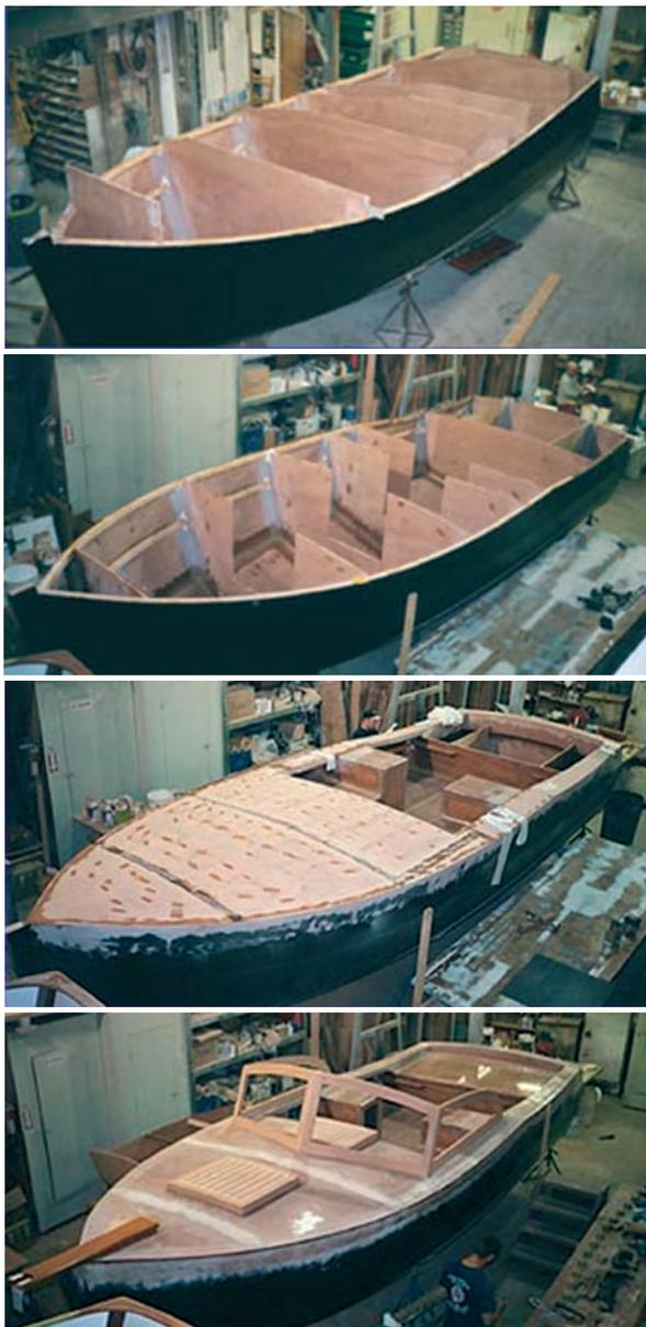
Рис.6-9. Достройка раскантованного корпуса по стадиям
