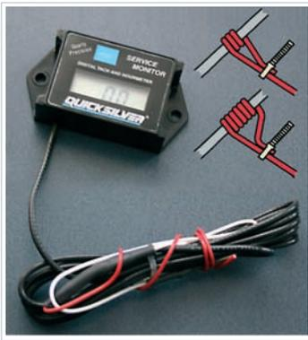
Цифровые тахометры "QUICKSILVER", считывающие импульсы на свечных проводах, пригодны для любых моторов и отличаются лишь исполнениями под двухтактники и четырехтактники. В зависимости от конкретной модели мотора провод передачи данных крепится на свечном тремя или шестью витками.
