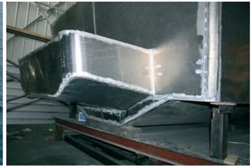
ВИД НА ТРАНЕЦ "АЛЯСКИ". ВИДНЫ ШИРОКАЯ ЛЫЖА И МОЩНЫЙ КРОНШТЕЙН ДЛЯ МОТОРОВ
