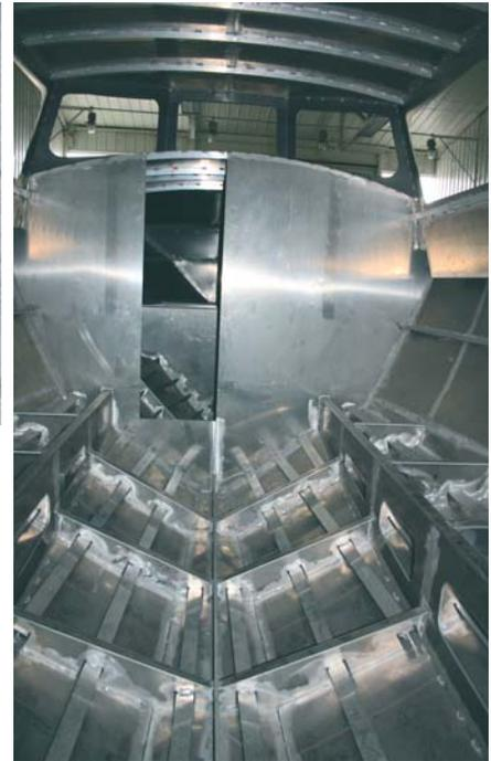
ЧАСТЫЙ ПОПЕРЕЧНЫЙ НАБОР ОБЕСПЕЧИВАЕТ ПОВЫШЕННУЮ ПРОЧНОСТЬ ДНИЩУ
