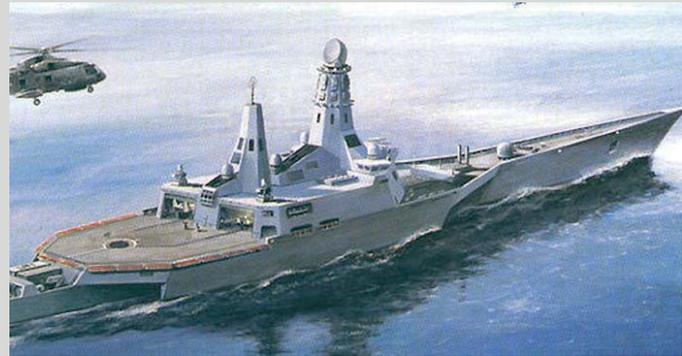
крупной серии (23 единицы?) фрегатов на базе проекта несколько увеличенного тримарана. По одному из вариантов проекта фрегат водоизмещением около 3000 т будет иметь длину 110 м и ширину 28 м. ЭУ мощностью 22 080 кВт обеспечит скорость полного хода 30 уз. При крейсерской скорости 18 уз дальность плавания составит 4500 миль. Особенность этого проекта в том, что центральный корпус выполнен с уменьшенной площадью ватерлинии (типа полуSWATH).
