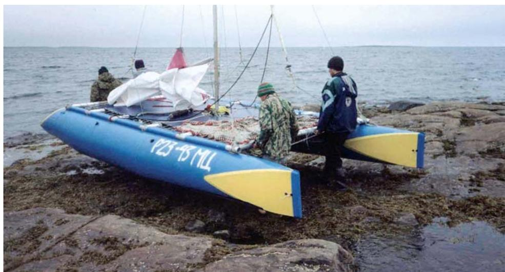
г. и показал себя как очень устойчивое, достаточно скоростное и хорошо управляемое судно. Вес его — около 140 кг, в собранном виде его могут переносить три-четыре члена экипажа, грузоподъемность — около 1000 кг (пять-шесть человек и груз).
