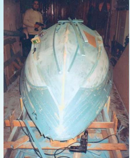
ражениям, что пенопластовому корпусу можно придать любую форму, снимая или приклеивая дополнительно слой пенопласта. Корпус получается очень прочным и обладает положительным запасом плавучести. Конечно, фанерный вариант можно построить намного быстрее, но он будет менее долговечен. Стоимость корпуса, формованного по набору, получается чуть дороже, чем при выклейке в матрице, но из-за одного корпуса изготавливать оснастку нет смысла.
