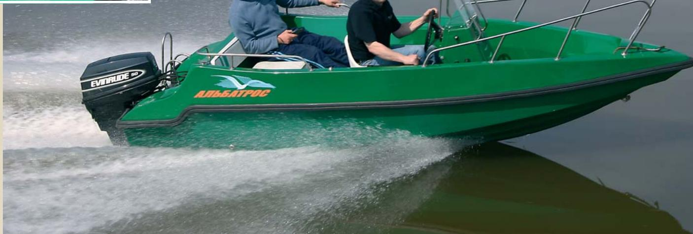
ватость здесь постепенно увеличивается от кормы к носу, начиная от довольно умеренных 14° на транце. За счет регулировки дифферента такой корпус легко настроить либо на «скоростной», либо на маневренный «спортивный» режим (в нем же достигается и наиболее мягкий ход по волне).
