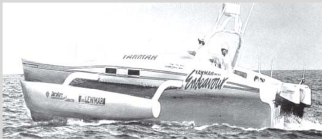
Прототип океанского тримарана-рекордсмена — 12-метровая мотолодка «Yanmar Endeavour», на которой был пересечен Тихий океан. Средняя скорость под двумя дизельными ПМ по 27 л.с. — 10 уз.
