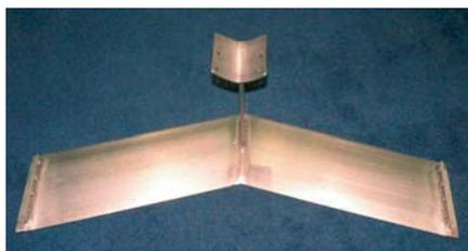
Подводное крыло для установки между корпусами моторного катамарана "Foiler 2200"
