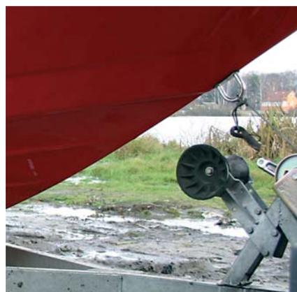
Рис. 3. Буксировать судно лучше всего за специальный рым на форштевне — при этом достигается наиболее оптимальный ходовой дифферент. Как правило, эта деталь имеется даже на маленьких надувнушках. На “трейлерных” лодках такой рым служит также для погрузки на прицеп.
