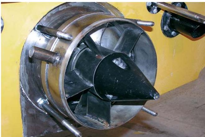
Вид на водомет со снятым соплом: титан и нержавеющая сталь
