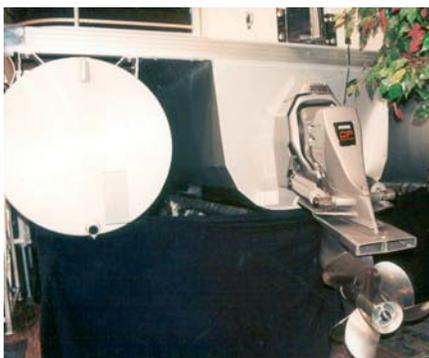
На простейшей понтонной лодке с цилиндрическими корпусами появилась кормовая наделка для установки колонки
