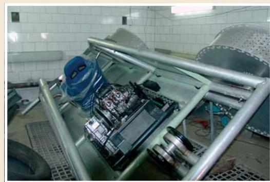
Идет монтаж двигателя и передач
