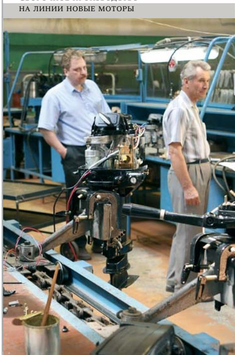
ИСПЫТАТЕЛЬНЫЙ СТЕНД, ОН ЖЕ СТЕНД ОБКАТКИ
