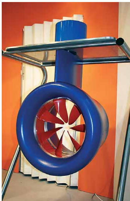
Новаторская конструкция подруливающего устройства с прямым электроприводом ротора
