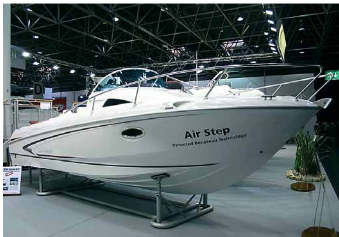
“BENETEAU-750” — КАТЕР С “НАСТОЯЩИМ”, НАПРАВЛЕННЫМ В НОС ВЕНТИЛИРУЕМЫМ СТРЕЛОВИДНЫМ РЕДАНОМ
