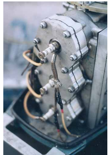
Головка блока цилиндров “Симбиоза-55”. На переднем плане — провода термодатчика от верхней свечи
