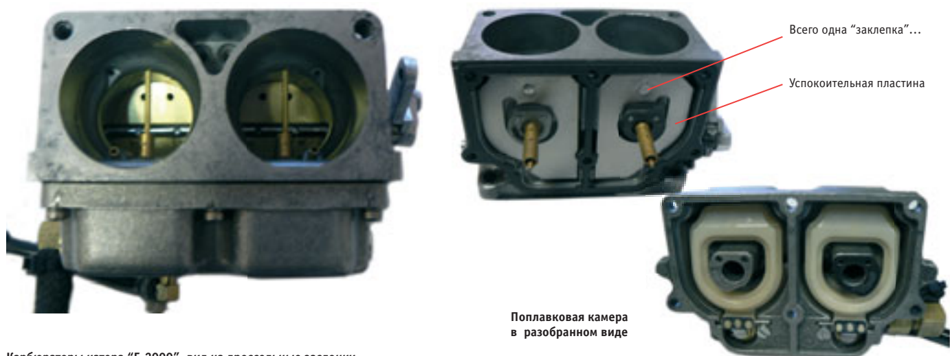
Карбюраторы катера "F-2000", вид на дроссельные заслонки
