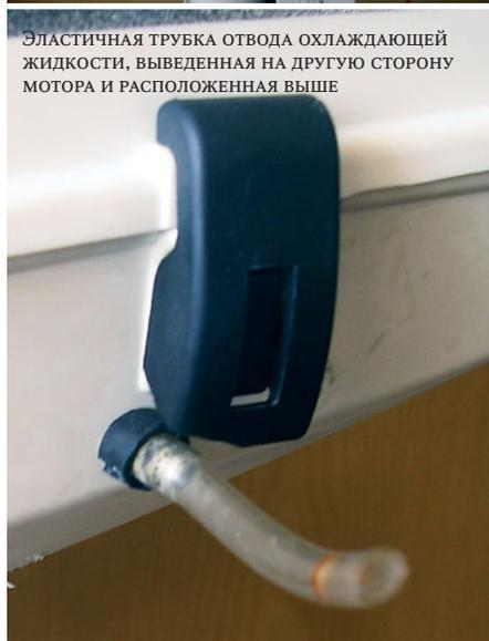
Эластичная трубка отвода охлаждающей
