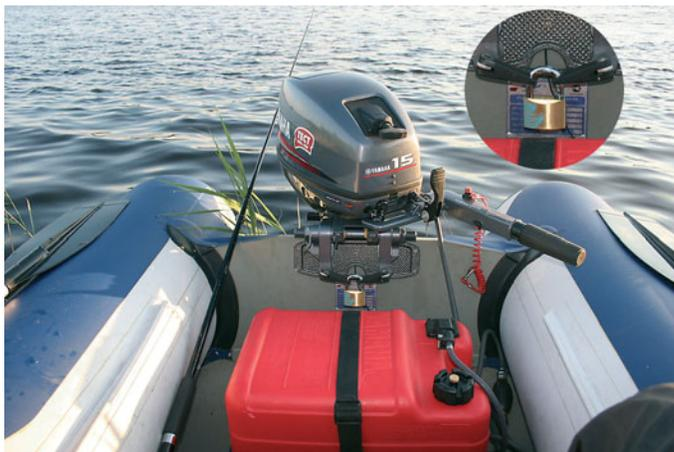
Бензобак к пайолу прикреплен только одним ремнем; хорошо видны на бортах тканевые ликтросы. На короткой стойке подвесник можно «замкнуть» за ручки струбцин.
