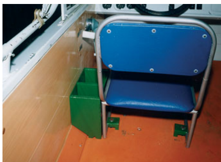
Рис. 11. Сиденье водителя с новыми креплениями и кассетой
