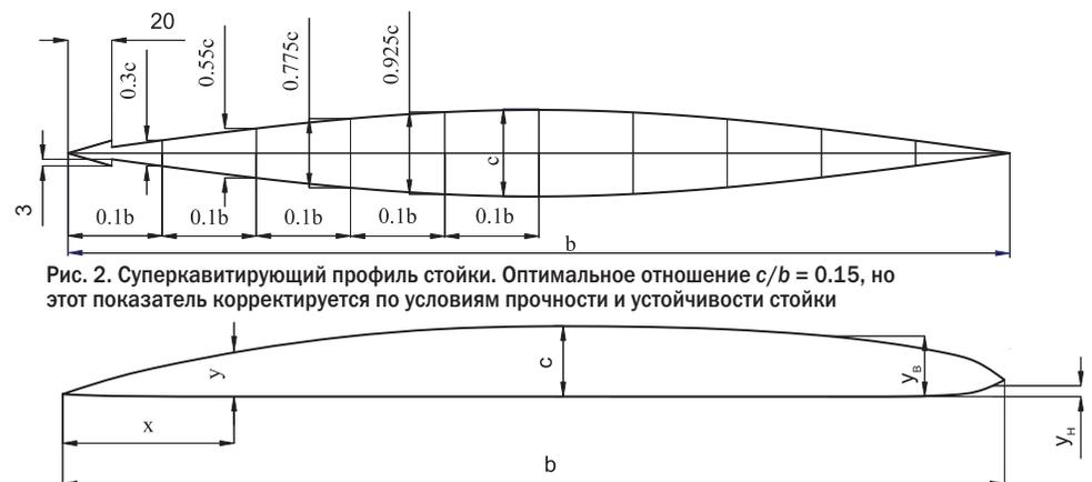
Рис. 2. Суперкавитирующий профиль стойки. Оптимальное отношение  $c/b = 0.15$ , но этот показатель корректируется по условиям прочности и устойчивости стойки
