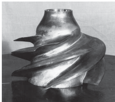
Шнековое рабочее колесо (импеллер) водометного движителя 96.
