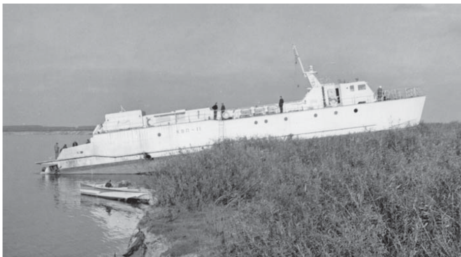
Аварийный выход на берег. Из данного положения катер КВП-11, оснащенный водометами ВД 22, самостоятельно снялся на воду.
