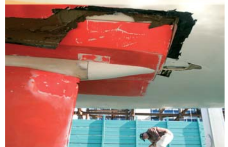
Очередной ремонт киля на «movistar»
