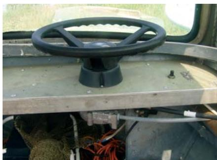
закрепить держатель троса (трубу) с помощью опоры на транце внутри лодки – сбоку от мотора. Но, когда проложили рулевой трос, выяснилось, что из-за его жесткости это сделать не удастся. Поскольку трубка для установки кабеля на «Нептуне» отсутствует, решили, как
