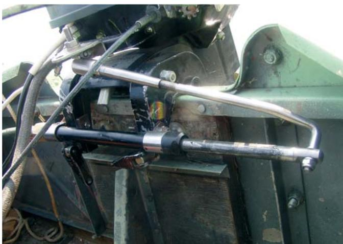
Так выглядит сборка со стороны мотора. Трубчатая опора троса крепится к струбцине.
