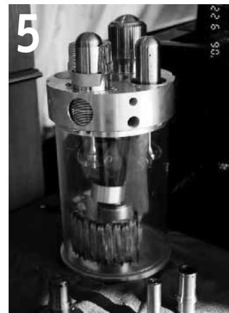
Итак, теоретический КПД «стирлинга» равен температуре горячего газа минус температура холодного газа, деленная на температуру горячего газа.
