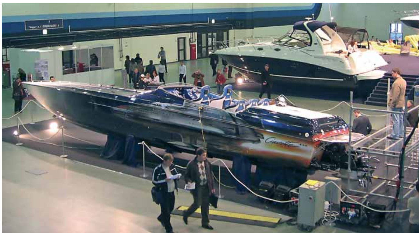
«Cigarette 46 Rider XP»: длина — 14 м, ширина — 2.44 м, вес — 5.8 т, килеватость — 24°, высота борта — 1.12 м, статическая осадка — 1.2 м; запас топлива — 1210 л. Стандартная силовая установка — два 8-цилиндровых V-образных бензиновых «Mercury Racing 850 SCi» (2x850 л.с.), максимальная скорость по результатам независимого теста — 92.7 уз (171.5 км/ч).
