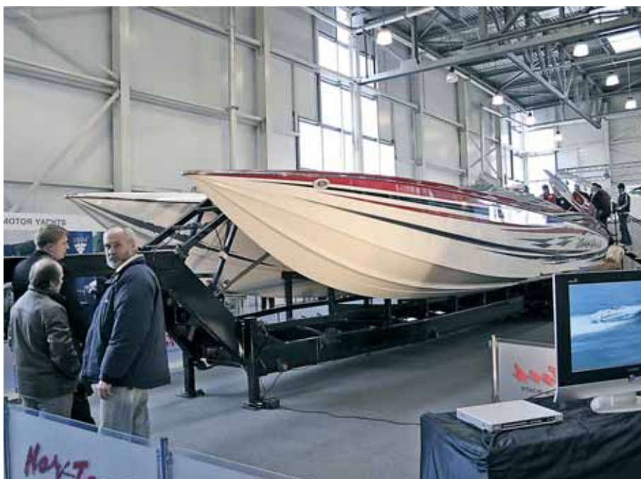
«Nor-Tech 5000 Super Cat»: длина — 15 м, ширина — 3,6 м, вес — 5,9 т, запас топлива — 1130 л. Стандартная силовая установка — два бензиновых «Nor-Tech 1150» (2×1150 л.с.) с угловыми колонками «Mercury Racing», заявленная скорость — 117 уз (217 км/ч).
