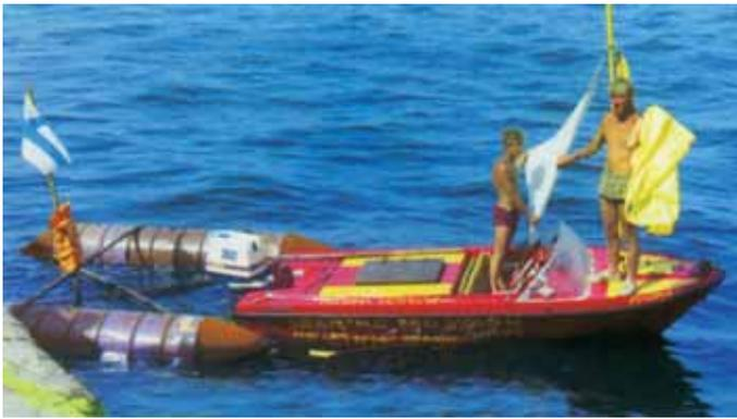
*Мотолодка «Психопат» (типа «Марино-Мустанг») перед выходом из Дакара (с буксируемыми наливными понтонами) и после приема на борт 250 л топлива*
