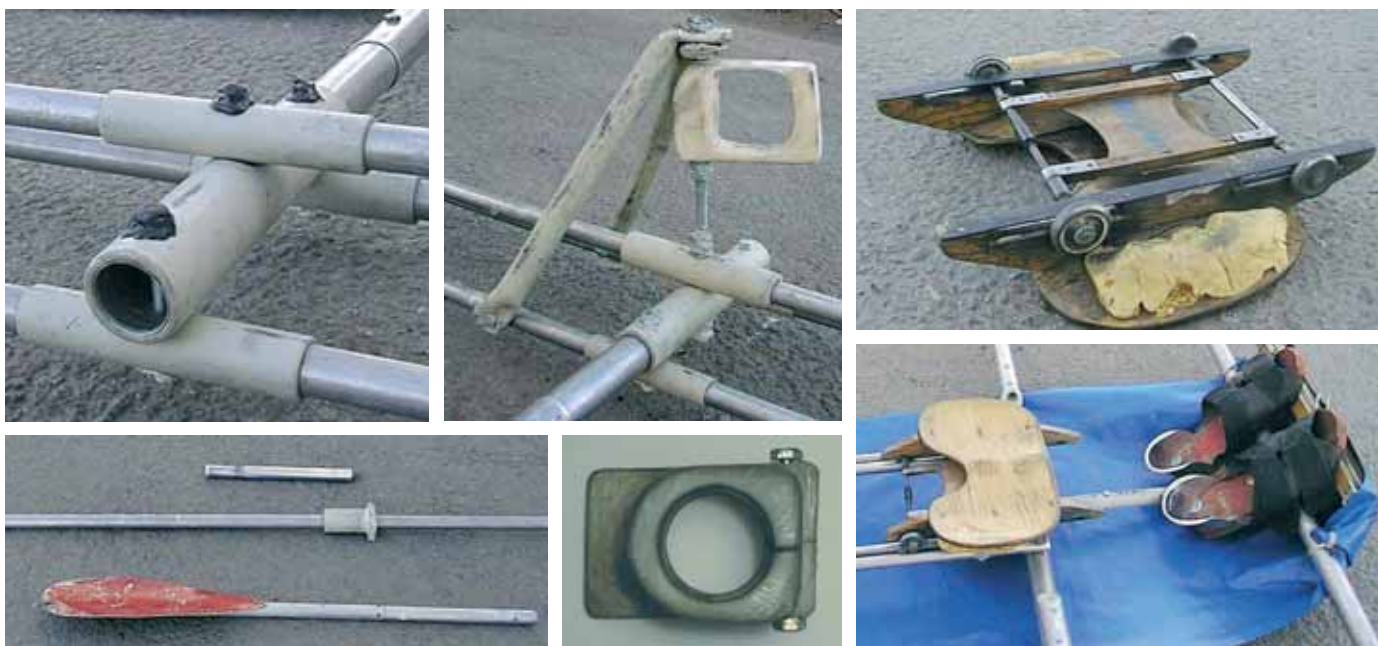
Отдельные узлы и детали лодки – угловой стык балок рамы, уключина, разборное весло, скользящее сиденье
