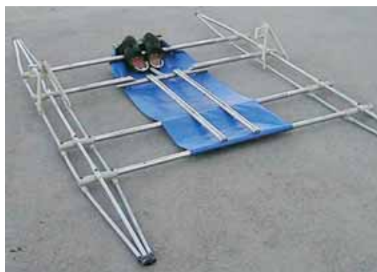
Рама гребного катамарана в сборе
