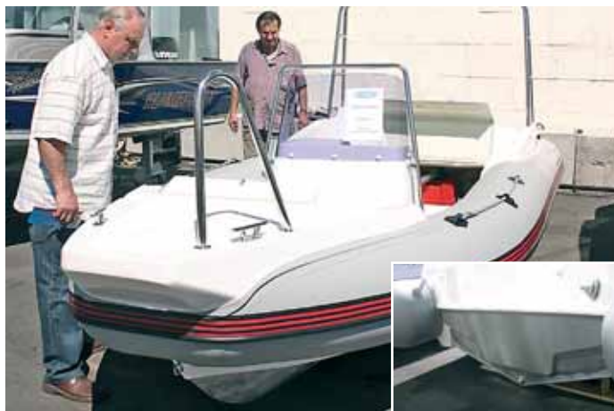
Необычный по конструкции РИБ производства «SkyBoat»: палуба пластиковая, а днище алюминиевое
