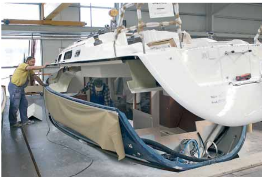
Оборудованный внутри корпус готовится к «стыковке» с палубой. Палубная секция уже полностью укомплектована всем необходимым: лебедками, погнами, релингами и прочим.
