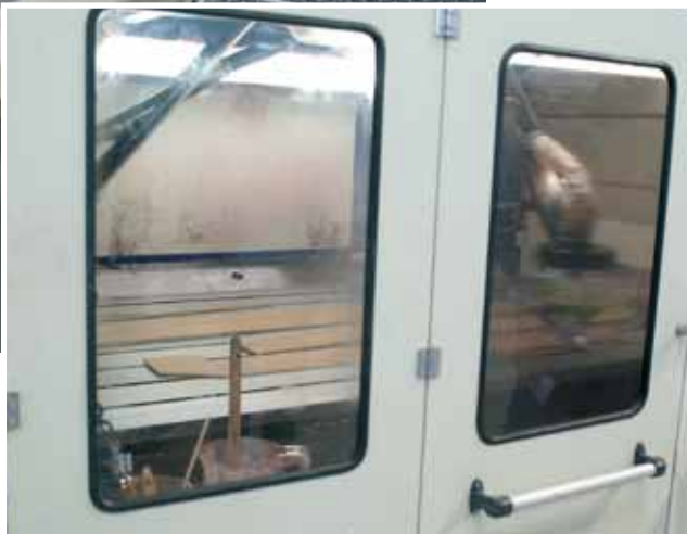
Поточная лакокрасочная камера. Каждая деревянная деталь «посещает» ее трижды. В итоге качество лакировки дерева получается высочайшим.
