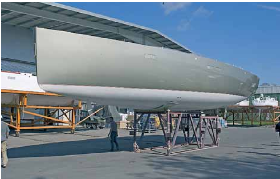
Завершающая часть конвейера – здесь готовые яхты оснащаются фальшкилями и рулями, после чего отправляются на воду
