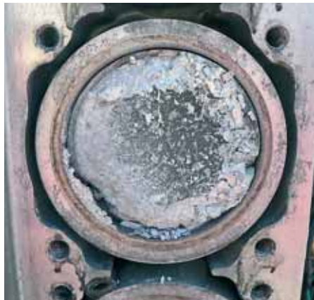
Результат работы мотора на «бедной смеси». Диагноз установлен – нарушения работы поплавковой камеры (мотор спортивный).
