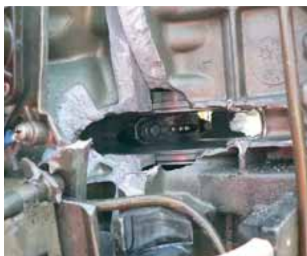
«Рука дружбы» – последствия работы одного из цилиндров мотора на «бедной смеси» (мотор спортивный)
