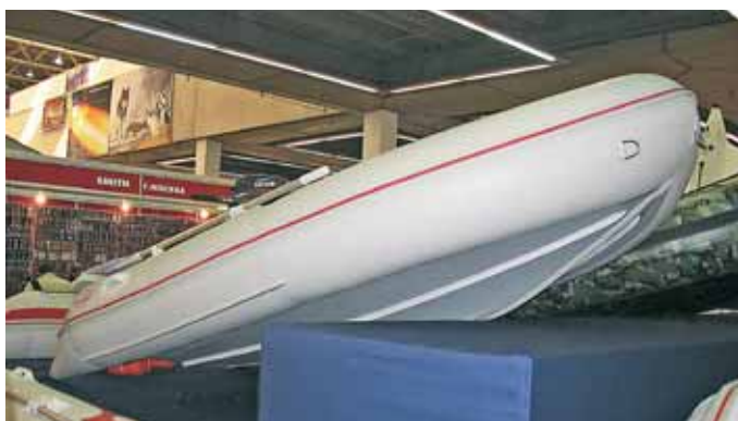
«Баджер» пошел по пути улучшения ходкости надувнушек с помощью продольного редандирования. Лодки «Solar» содержат множество необычных конструктивных «изюминок»
